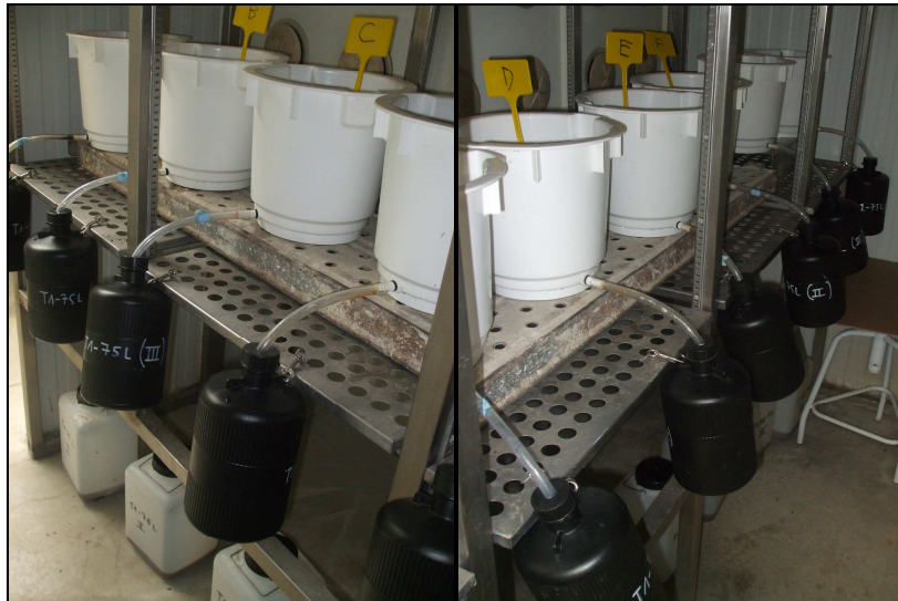
Figura 4. Macetas de 2 litros con compost y sustrato base introducidas en recipientes tipo "Mitscherlich" (blanco) junto con el sistema de recolección del líquido drenado (negro).
