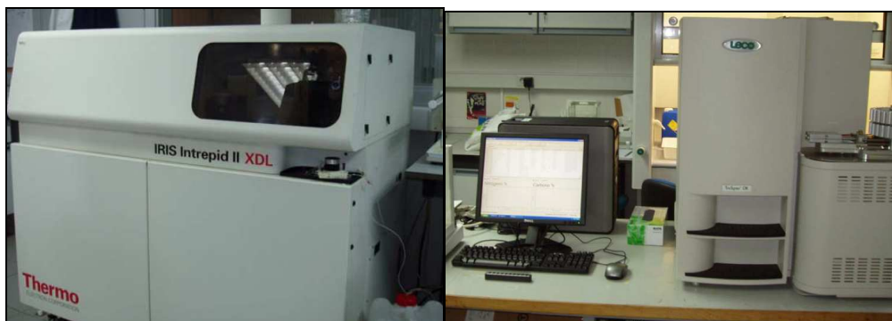
Figura 6. Aparato de medida de metales pesados y microelementos (P, K, Mg, Ca, y S): IRIS INTREPID II XDL THERMO y medidor de C y N: LECO TRUSPEC CN empleados.
