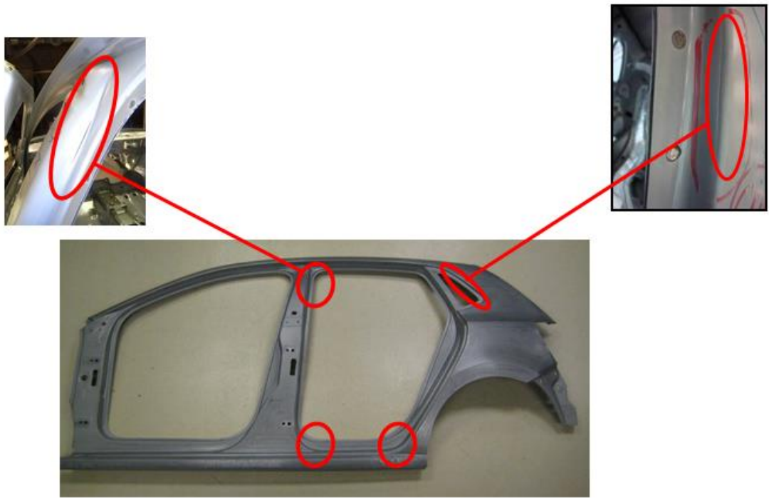
Figura 74. Zonas críticas lateral izquierdo 4 puertas
