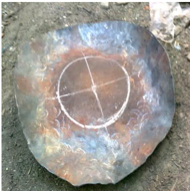
Figura 56. Foto pieza con arrugas formadas en la embutición
