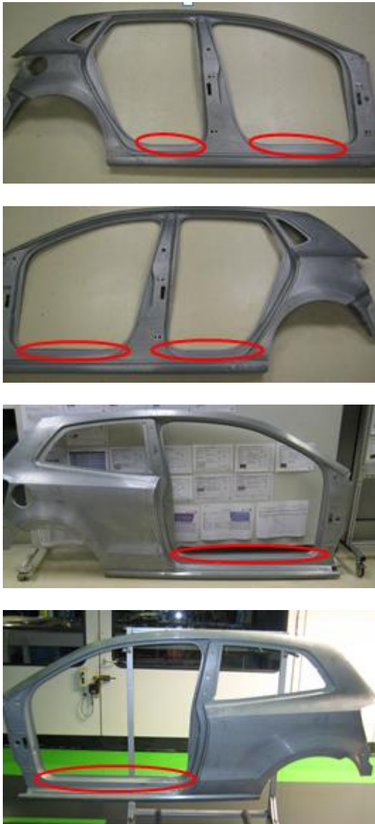
Figura 137. Zonas críticas de los laterales
