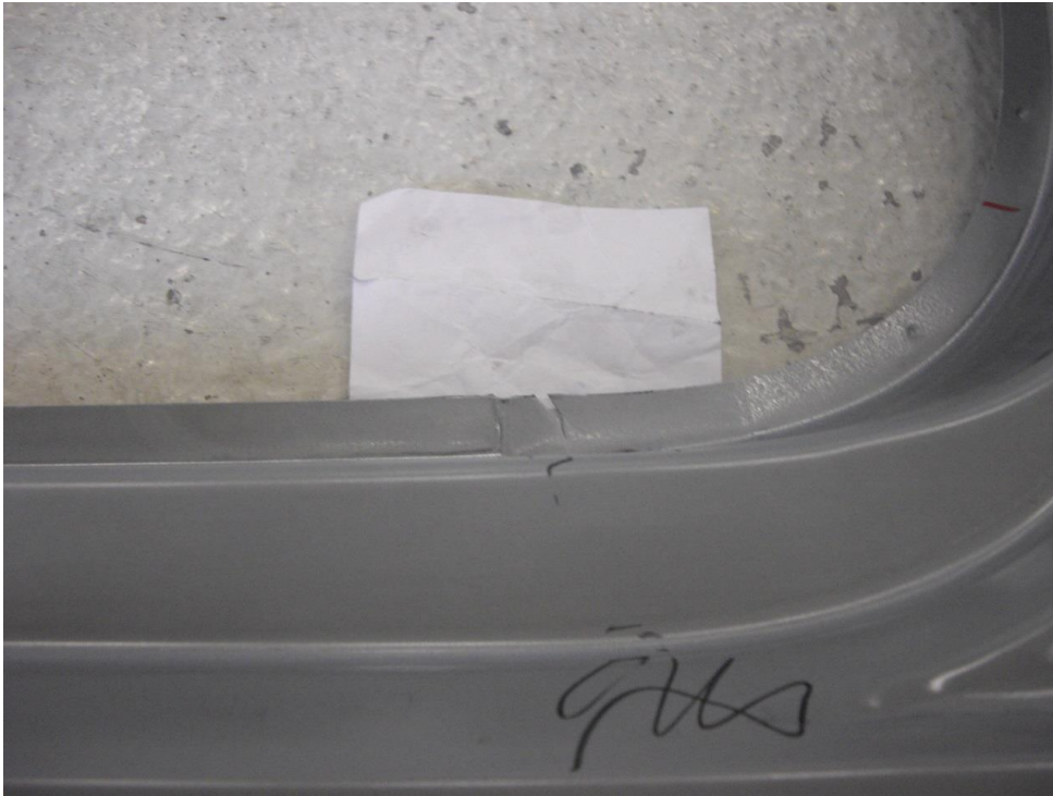
Figura 78. Zona de la grieta del lateral de la figura 76
