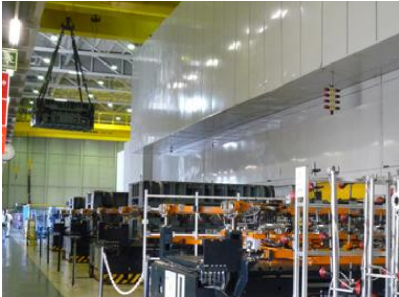
Figura 22. Transporte de un troquel de la Erfurt mediante el uso de un puente grúa[20]
