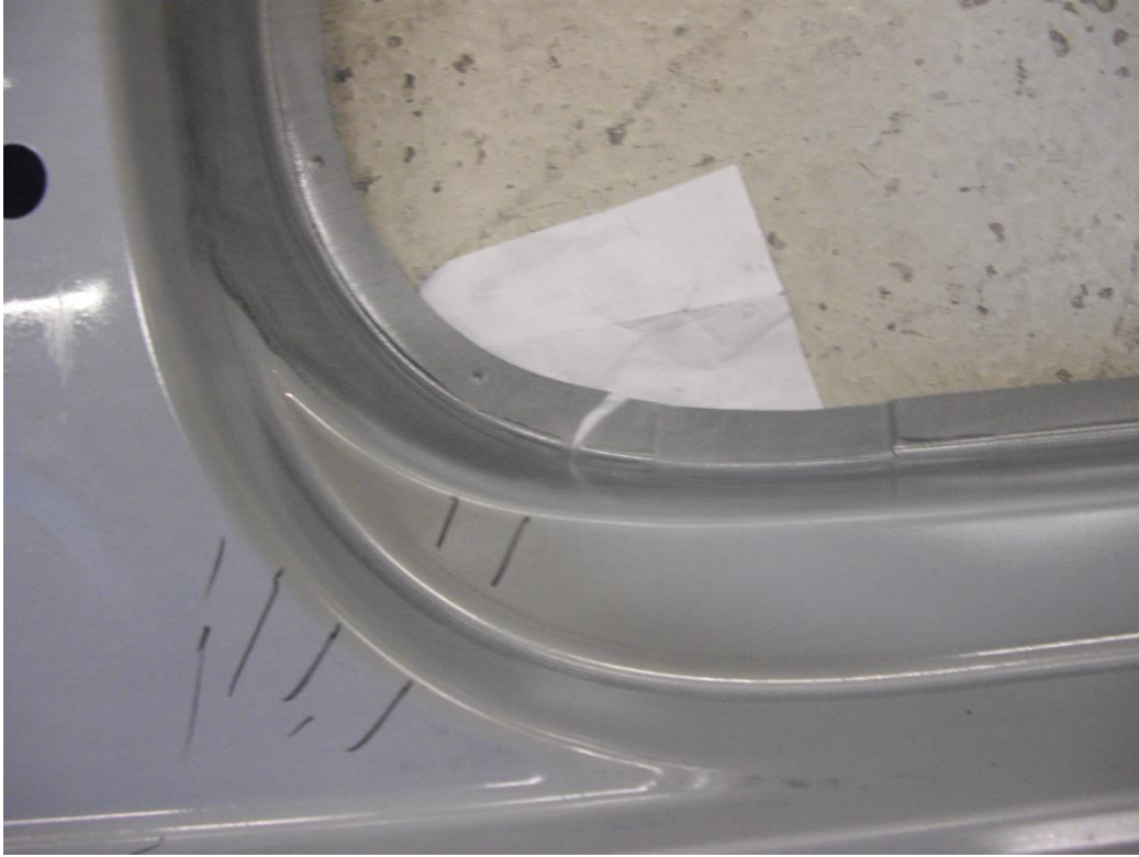
Figura 80. Zona de la grieta del lateral de la figura 78
