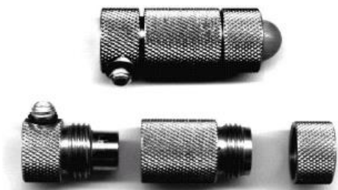
Figura 130. Transductores ultrasonidos de columna de agua
