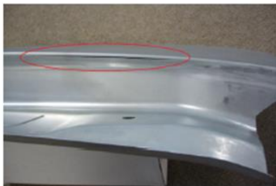
Figura 142. Foto grieta e imagen resultado del ensayo
