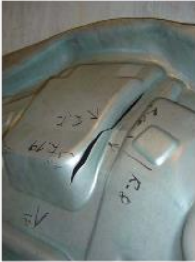
Figura 55. Foto grieta en la embutición [2]
