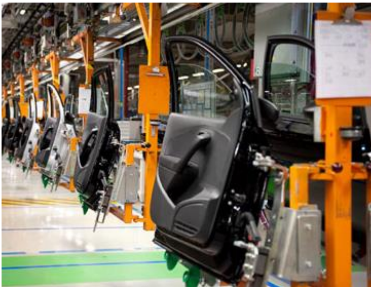
Figura 16. Línea de montaje de puertas en la nave de motores (20)
