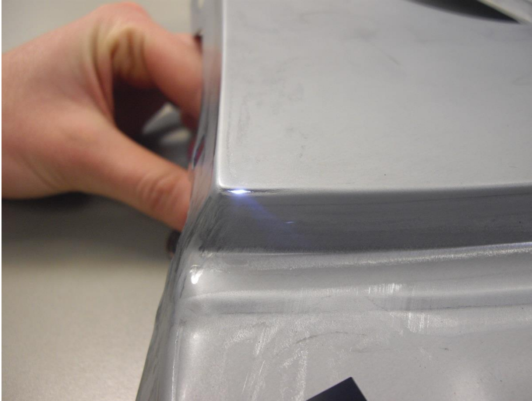
Figura 82. Grieta de la muestra de la figura 80
