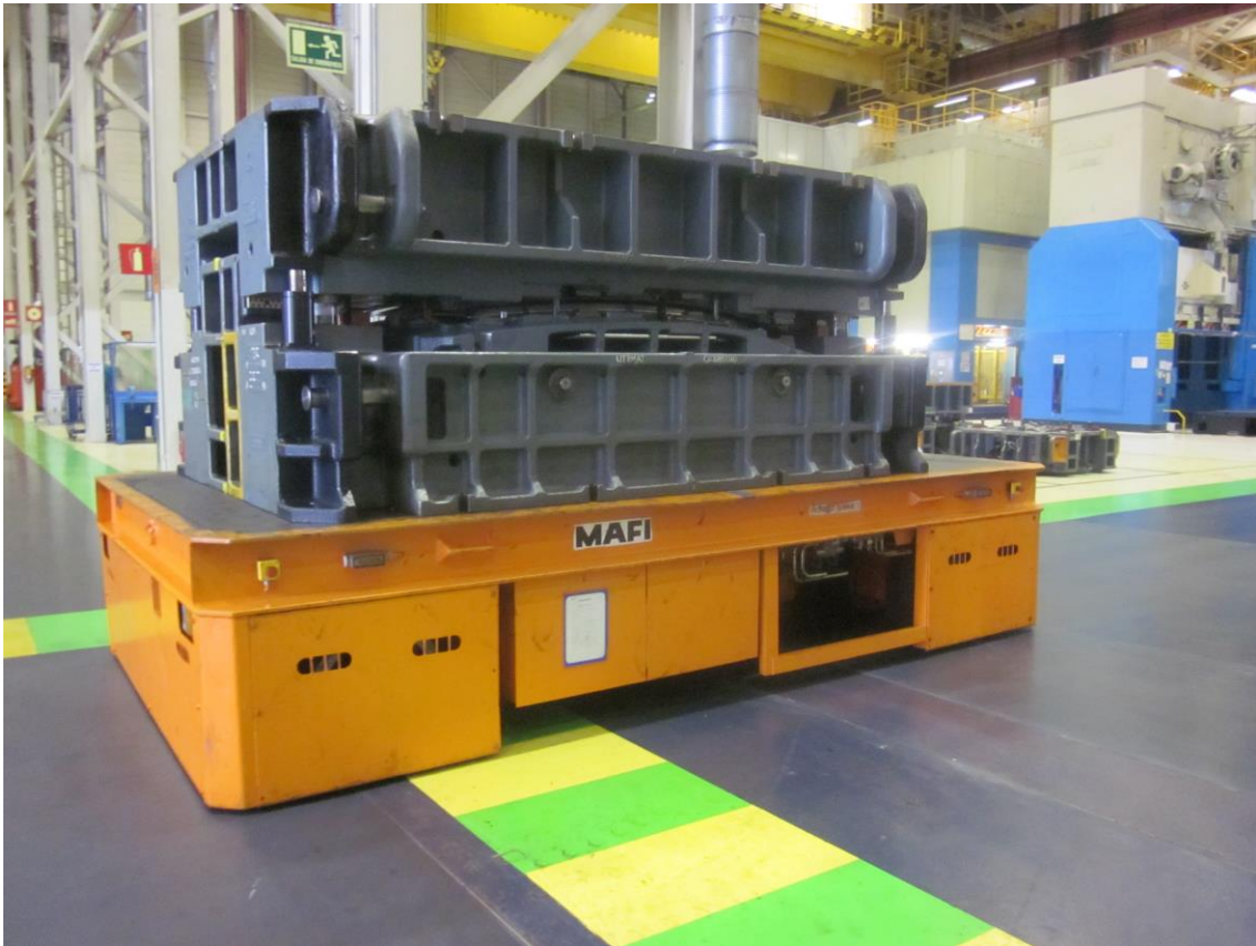
Figura 70. Foto de máquina MAFI transportando un troquel en la nave de prensas de VW Navarra
