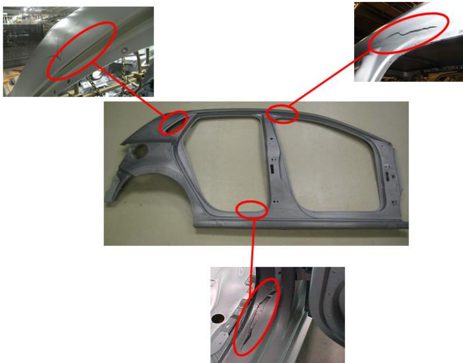
Figura 73. Zonas críticas lateral derecho 4 puertas
