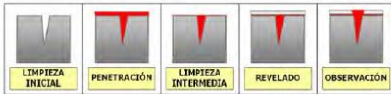
Figura 89. Dibujo distintas fases líquidos penetrantes [4]
