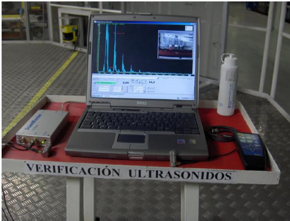
Figura 128. Dispositivo control por ultrasonidos VW Navarra
