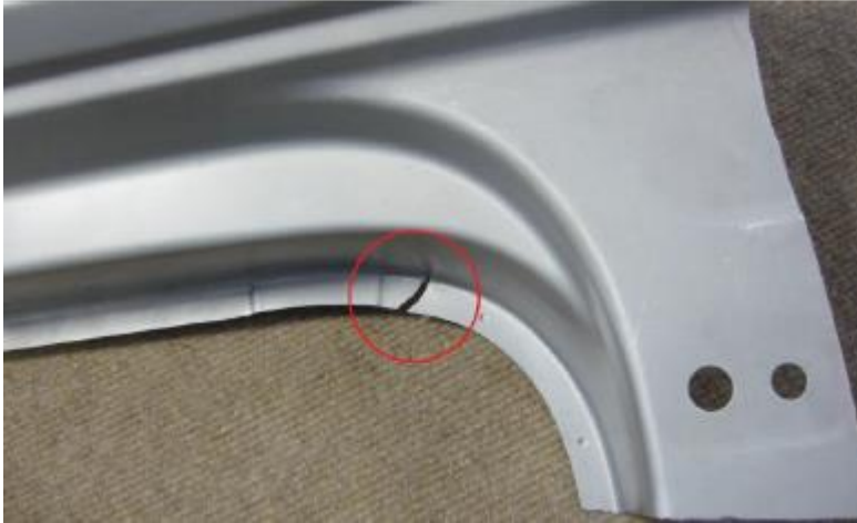
Figura 138. Ejemplo grieta talonera del lateral
