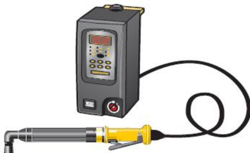
Figura 3.8. Herramientas electrónicas con unidad de control.
