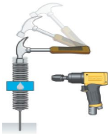
Figura 3.5 .Principio de las herramientas de impulso.
