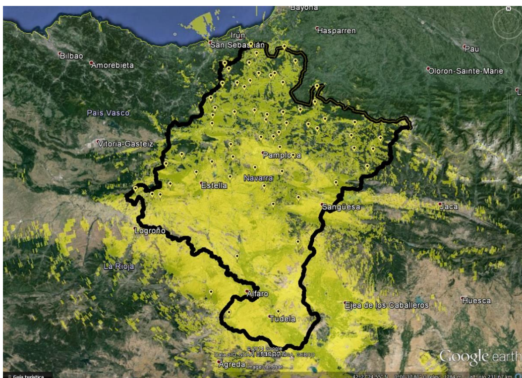
Figura 3.23: Simulación realizada con Radio Mobile de la cobertura actual del canal de televisión autonómica de Navarra.
