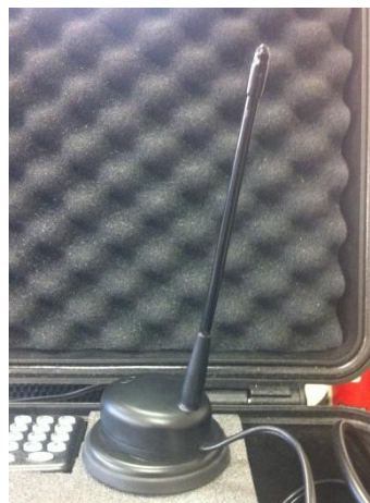
Figura 4.65: Antena Tetra/GPS del maletín de medidas
