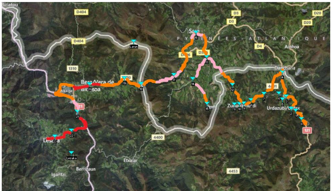
Figura 4.20: Cobertura de la Estación nueva de Larun desconectando Lesaka
