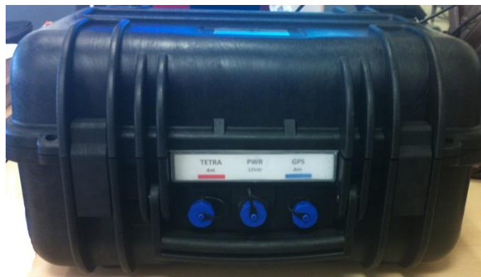
Figura 4.64: Maletín de medidas de Potencia de la Red Tetra de Navarra.
