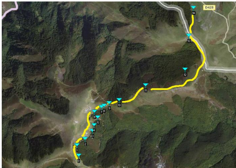
Figura 4.37: Localización de los puntos para realizar el estudio de la Potencia Recibida mediante Radioenlaces desde la Estación de Abodi en la Parte del Camino de Santiago
