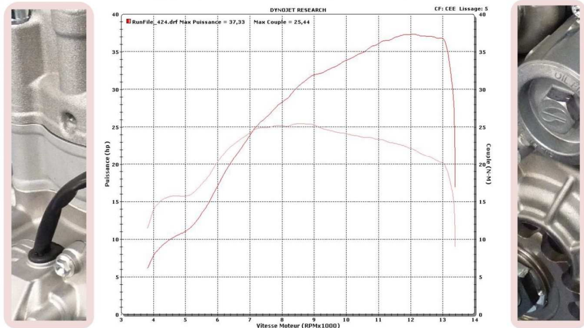
Figura 24: Curva de potencia y par del motor de combustión interna
