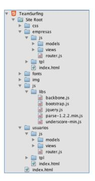
De esta manera, las librerías necesarias para el funcionamiento de toda la aplicación (¡Query.js, Backbone.js, Bootstrap.js, Parse.js y Underscore.js) se encuentran en raíz del proyecto junto con los glyphicons, 180 iconos creados mediante una fuente especial llamada Glyphicon Halflings, las imágenes que utilizaremos en toda la aplicación y las hojas de estilos, comunes también a toda la aplicación.
