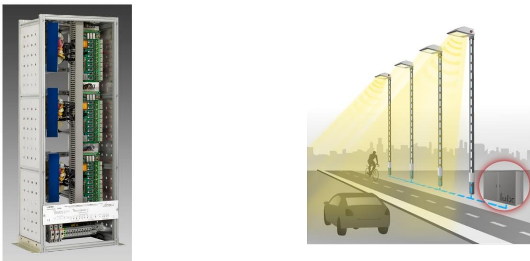
Figura 3.1: Cuadro de mando para la regulación en cabecera y posicionamiento en la instalación.
