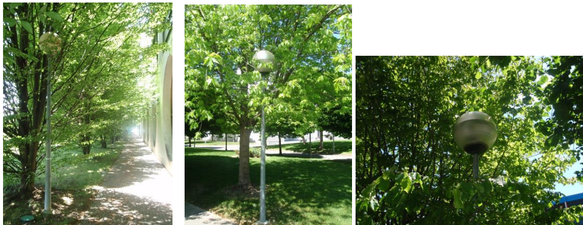
Ilustración 7-2: Imágenes tomadas en la UPNA de luminarias con obstáculos que limitan su eficiencia
