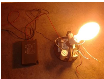
Figura 4.2: Balastro electrónico de doble nivel.
