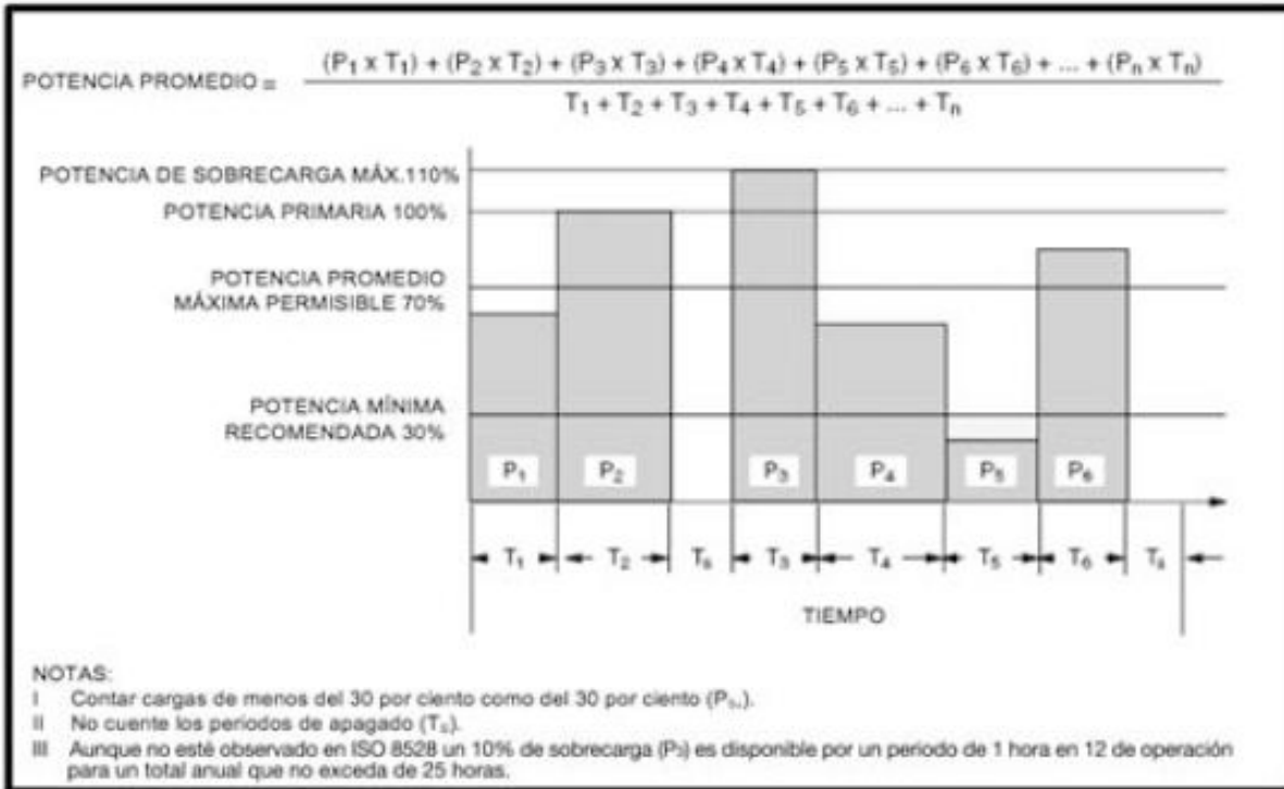
Figura II.2: Rango de potencia primaria con tiempo de operación ilimitado
