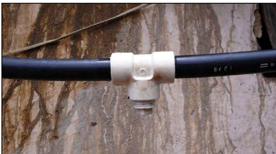
Figura 10.4: Trampa de agua en forma de T
