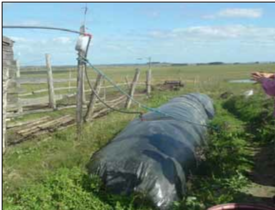
Figura 10.2: Gasómetro de polietileno de bajo costo para almacenamiento de biogás.
