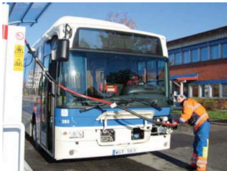
Figura 3.3: Bus urbano propulsado por biogás en Västerås (Suecia)
