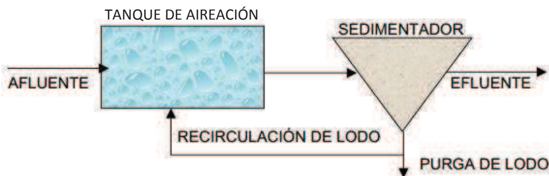
Figura 4. Esquema de un sistema de fangos activos. (VALENCIA y RIVERA 2003)
