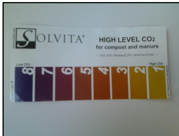
Imagen 19: Test Solvita (Dióxido de carbono CO 2 )
