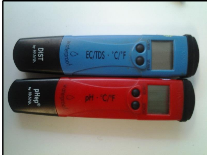
Imagen 20: Peachímetro digital y conductímetro digital.
