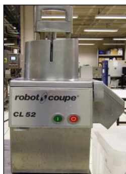
Figura 25: Cortadora industrial ROBOT-COUCPE para lonchear las patatas
