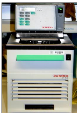
Figura 22: Criotermostato de circulación utilizado para atemperar los extractos de PPOp
