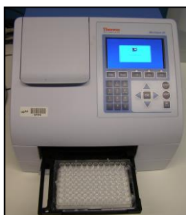
Figura 23: Espectrofotómetro MULTISKAN con microplaca 96 pocillos
