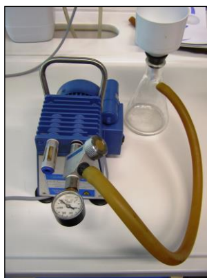
Figura 20: Bomba de vacío VACUUBRAND para poder separar la parte sólida de la líquida
