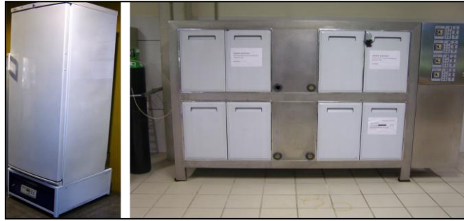
Figura 18: Cámara frigorífica TARRE (derecha) almacenamiento de la materia prima y Ultracongelador Vertical CLIMAS (izquierda) almacenamiento de la enzima PPO
