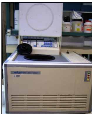
Figura 21: Centrífuga SIGMA utilizada para la separación de fases
