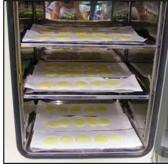
Figura 34: Almacenamiento de las lonchas de patata en estufa de convección a 25\pm 1 °C y 75%H.R durante 48 horas
