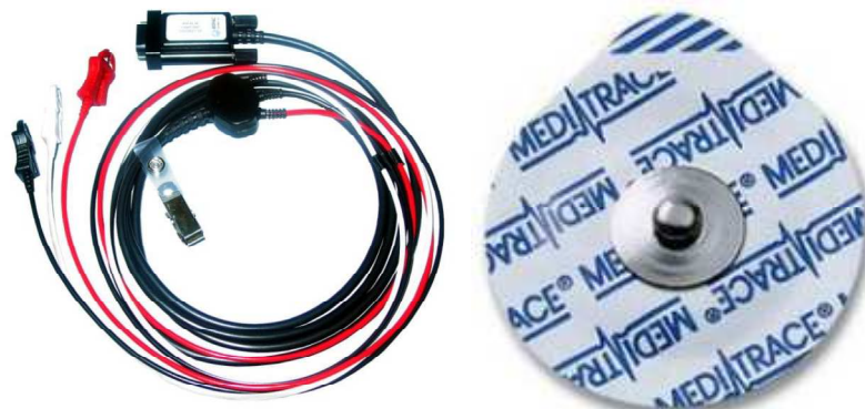
Figura 15. Cable SS2L y electrodos empleados para captación
