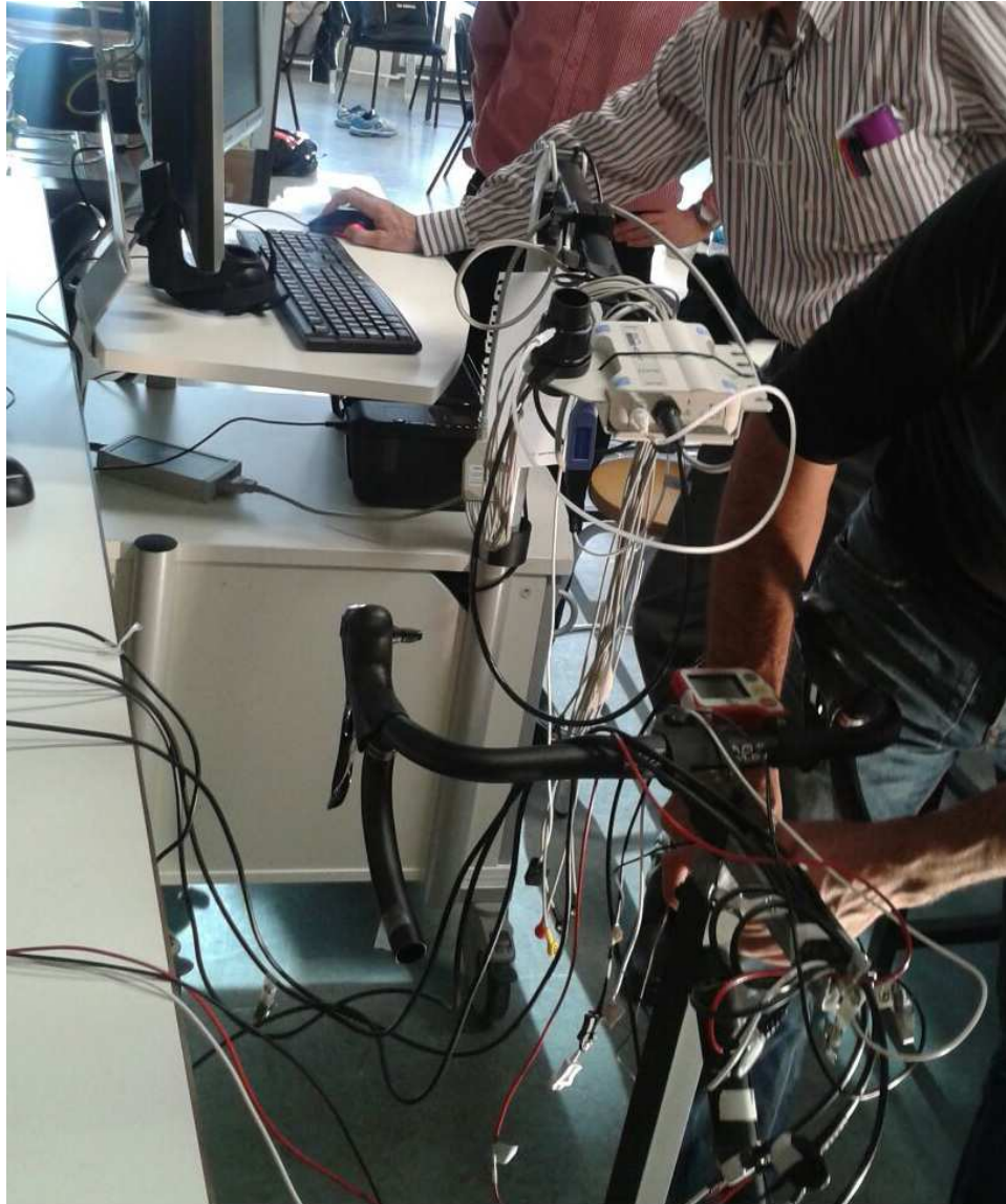
Figura 19. Sistema Oxycon Mobile dispuesto previo al test incremental
