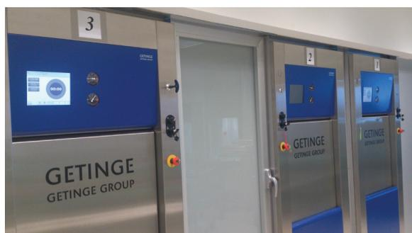
Fig. 3. Autoclaves de vapor
