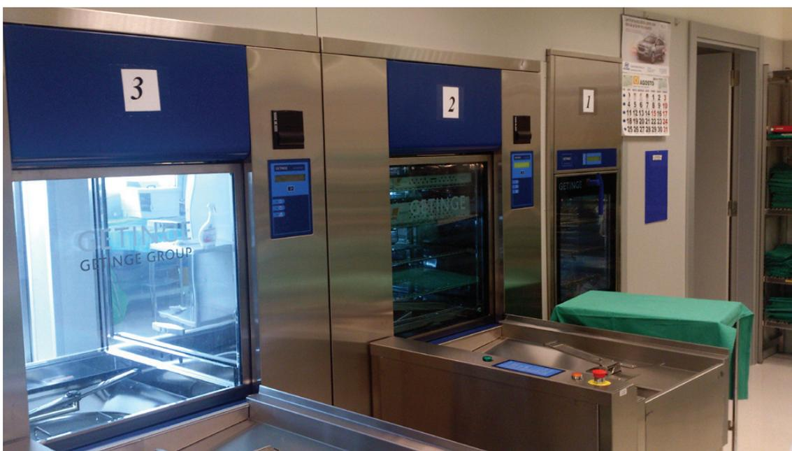
Fig. 2. Puertas de descarga de lavadores desinfectadores
