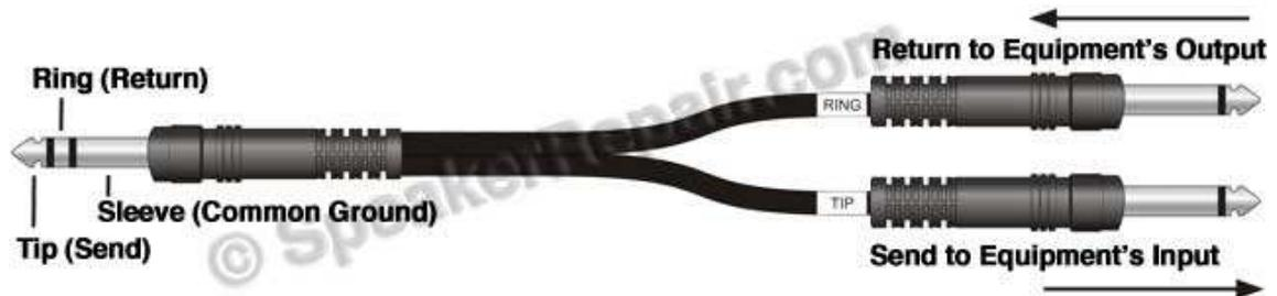
Figura 5: Ejemplo cable insert, en "Y" [SPR2013].
