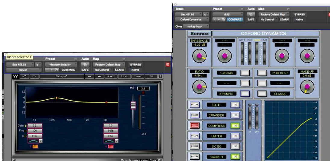
Figura 87: Ecuación y compresión saxofón.
