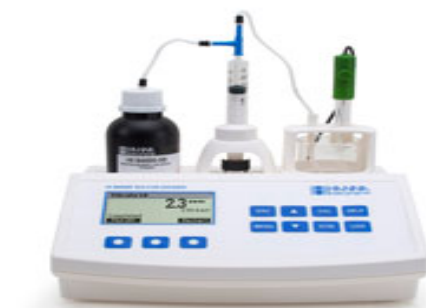
Figura 4.3: Equipo Hanna Instruments HI-84500 para determinar dióxido de azufre
