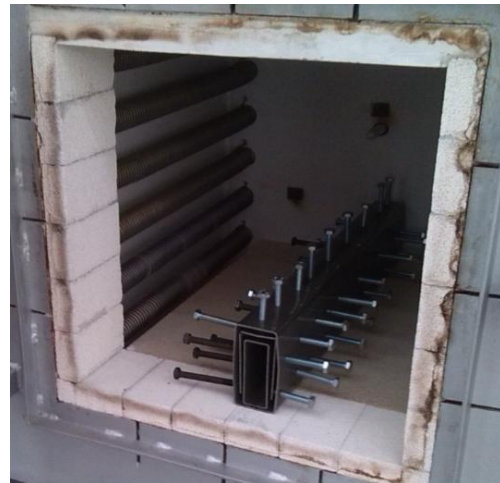
Figura 10.6: Montaje final e introducción a un horno.
