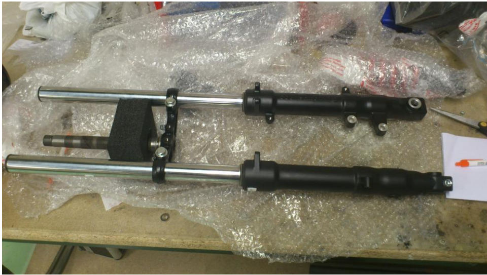
Figura 3.1: Suspensión delantera proporcionada por la organización.
