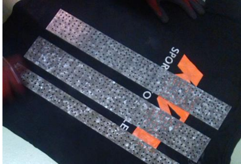
Figura 10.5: placas para ejercer la presión.
