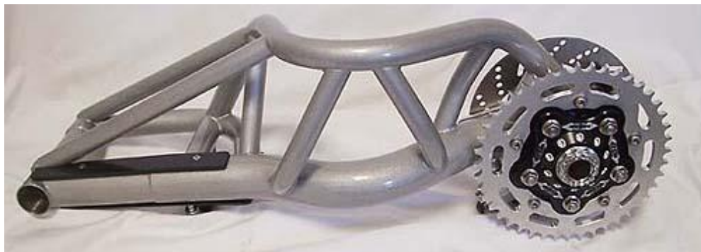
Figura 4.1: Basculante monobrazo Suzuki GSR-X
