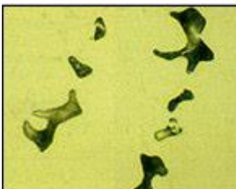
10. **Colas de cometa:** aparecen junto con las inclusiones o los poros cuando el movimiento relativo de la muestra y el disco es unidireccional. Se evita realizando movimientos en todas las direcciones de pulido.
