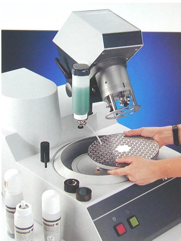
Figura 27: Pulidora metalográfica.
