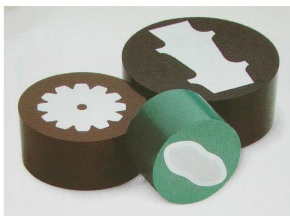
Figura 20: Inclusiones metalográficas en caliente.
