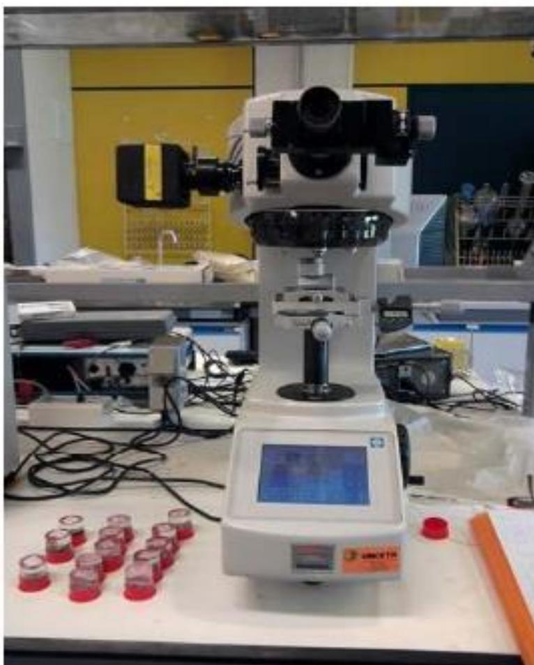
**Figura 122:** Equipo de microdureza Vickers HM-200 Series Mitutoyo.
