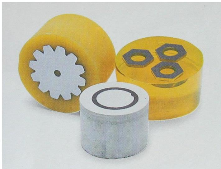
**Figura 21:** Inclusiones metalográficas en frío.
