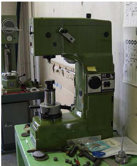
Figura 124: Medidor de dureza Rockwell
