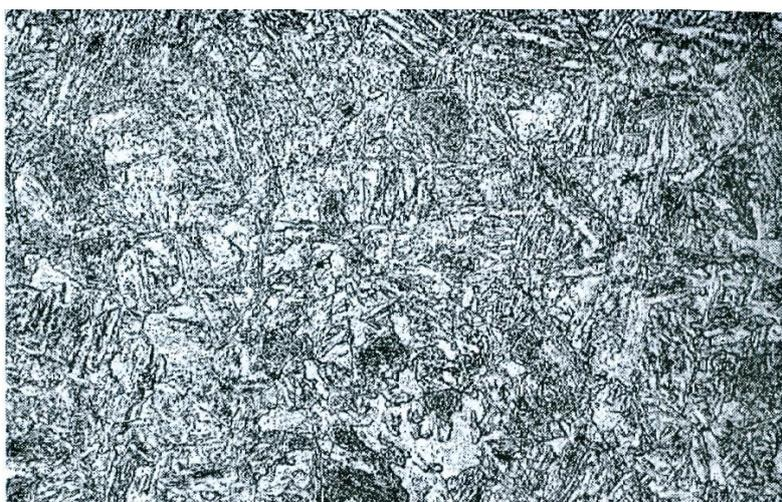
**Figura 60:** Estructura de martensita revenida.
