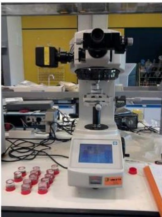
Figura 43: Equipo de microdureza Vickers HM-200 Series Mitutoyo.
