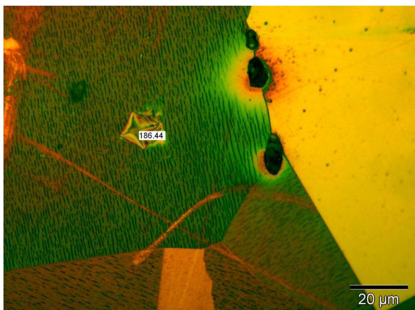
Medición de la dureza en un grano de austenita (X1000).
