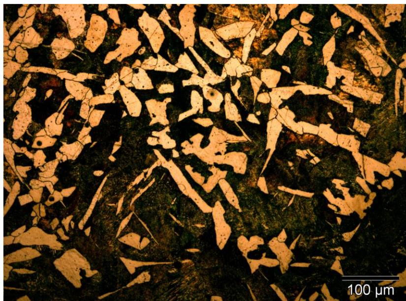
**Figura 95:** Acero hipoeutectoide de un contenido de carbono de 0,45% (x200).
