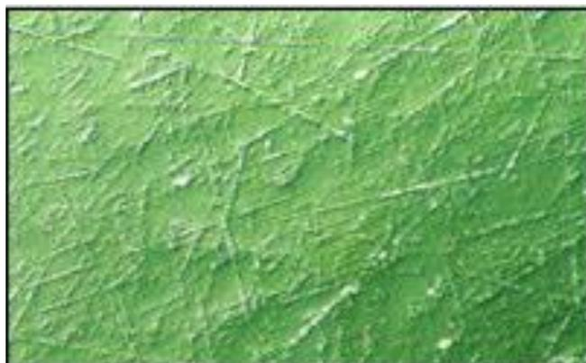
3. **Aplastamiento:** es la deformación plástica de grandes zonas de la muestra. Se pueden producir por una elección incorrecta del abrasivo, lubricante o paño.
