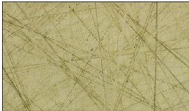
2. **Deformación plástica:** puede provocar defectos superficiales después del esmerilado o el pulido. Se revela después del ataque.
