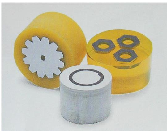
**Figura 84:** Muestras encapsuladas en resina.
