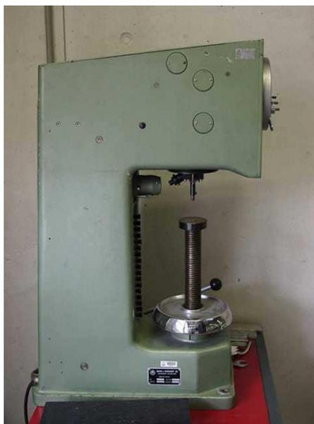
**Figura 119:** Prensa para ensayo Brinell.
