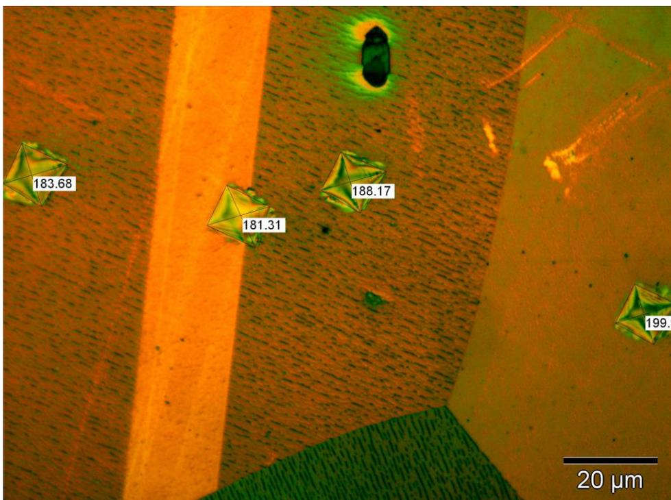
Medición de dureza en 4 diferentes granos, con el programa análisis de imagen (x1000).
