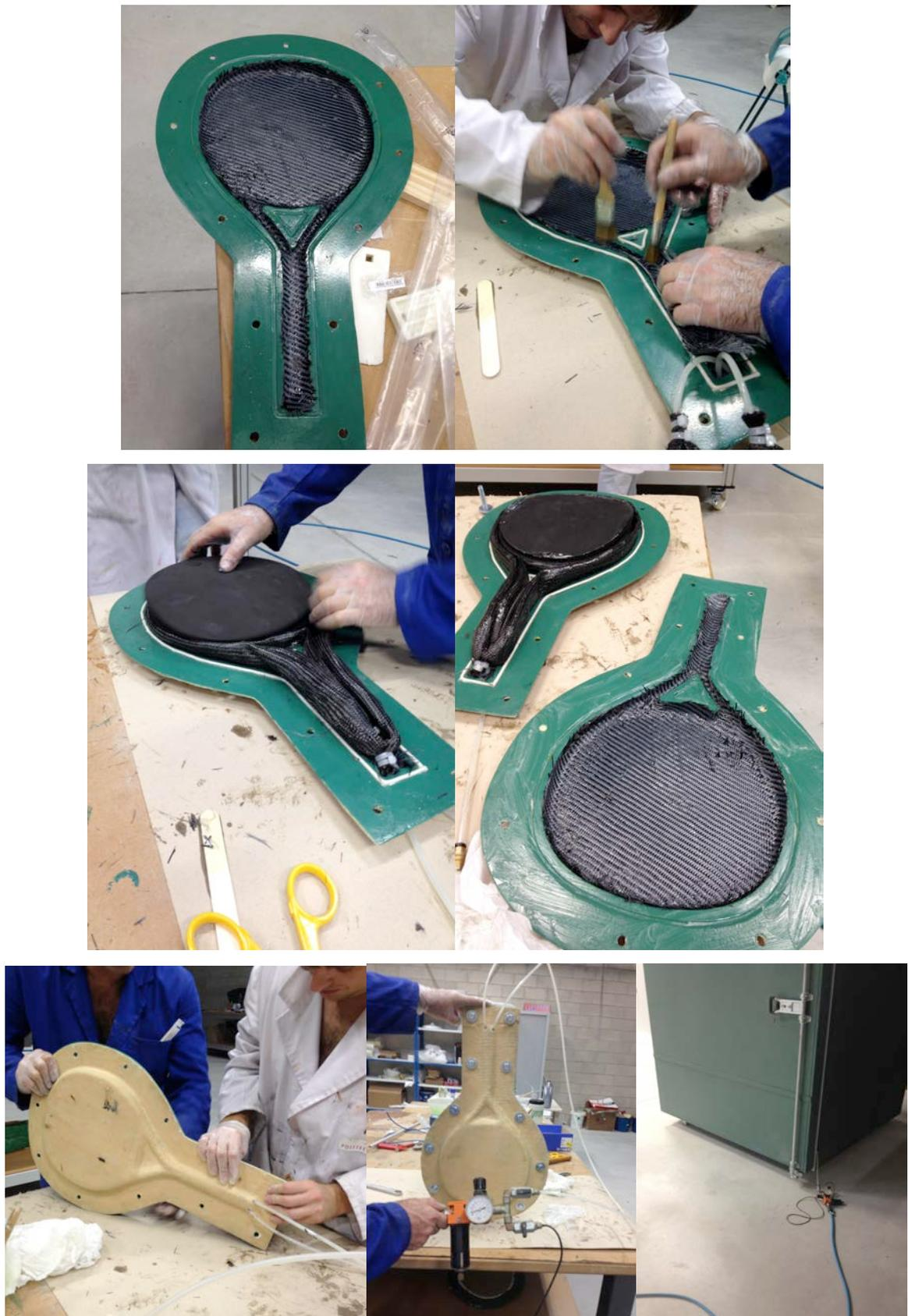
Figura 5.15 Proceso de fabricación de la pala
