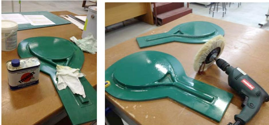
Figura 5.12 Pulido y limpieza del positivo utilizado para la fabricación del molde
