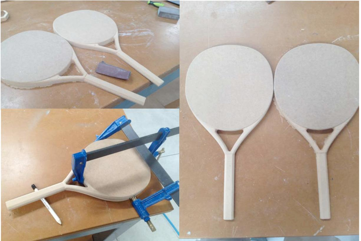
Figura 5.5 Diferentes momentos del mecanizado en el pantógrafo
