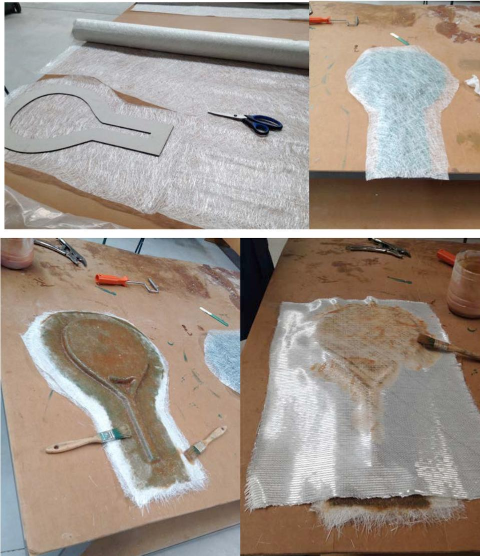
Figura 5.13 Proceso de fabricación del molde
