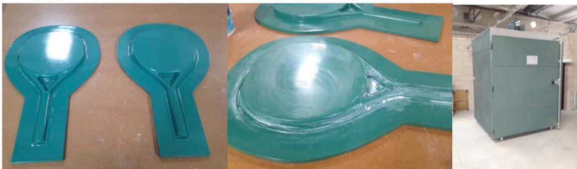
Figura 5.11 Proceso de la fabricación del positivo.
