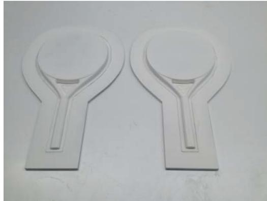
Figura 5.10 Positivo para la fabricación del molde pintado
