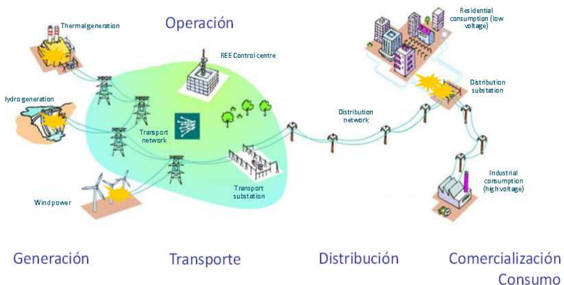
Gráfico 2. Diagrama esquematizado del sistema eléctrico
