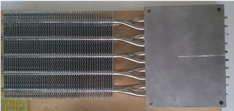
Figura 23: Heat pipe de la marca QUICK-OHM
