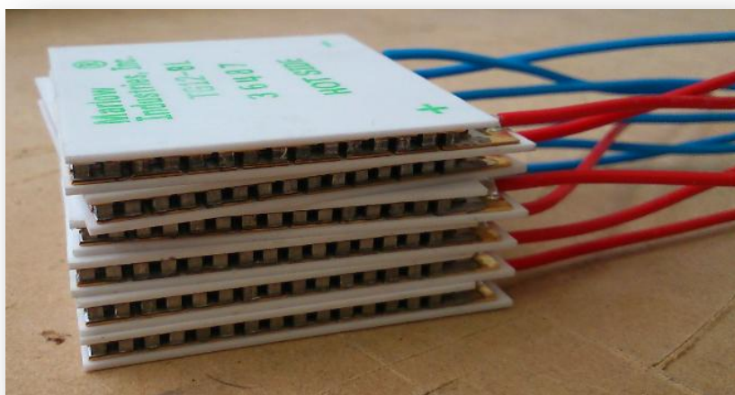
Figura 22: Módulos termoeléctricos TG12-8L de Marlow Industries, Inc.
