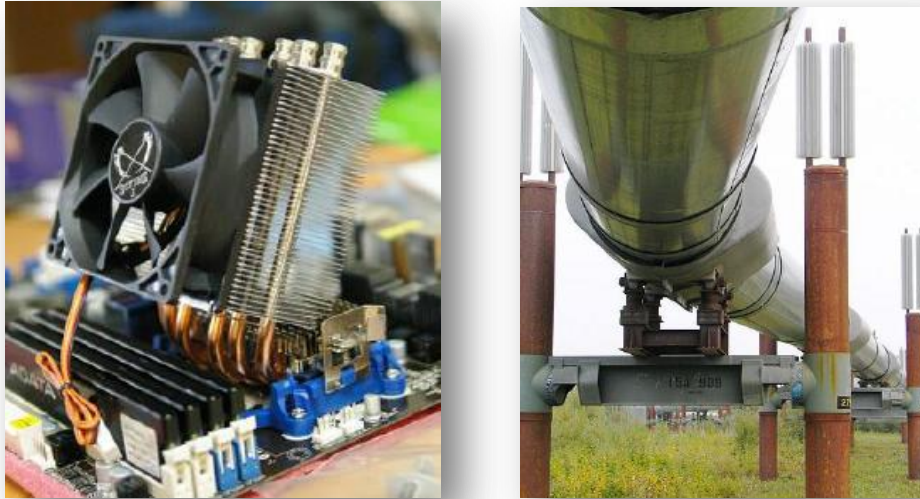
Figura 12: Distintas aplicaciones de Heat Pipe (electrónica y grandes instalaciones)
