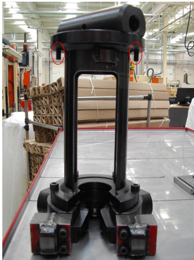
Fig. 110: Utilaje de rebordeado RR
