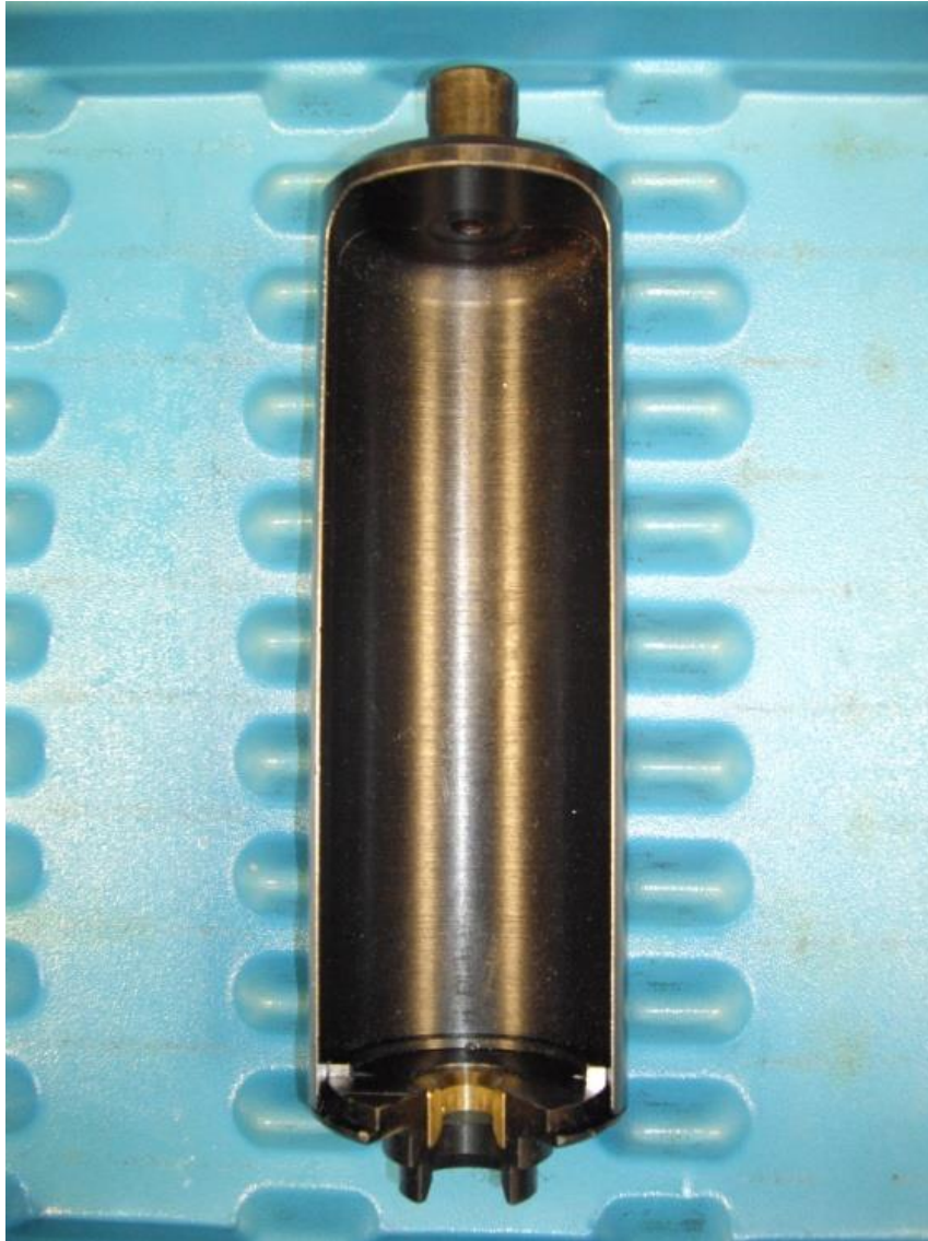
Fig. 101: Utillaje de calado del amortiguador RR
