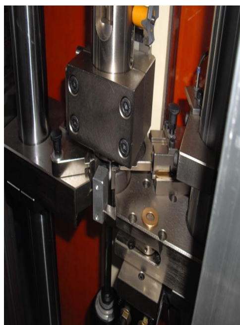
Fig. 98: Verificación con pasa no pasa
