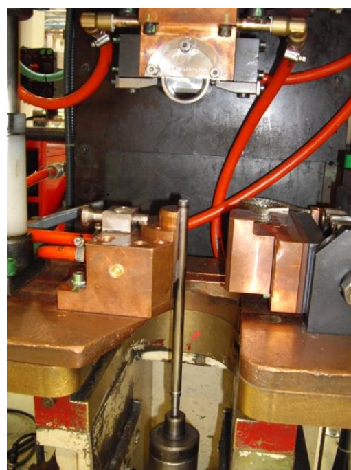
Fig. 75: Punteadora con vástago y anillo colocados
