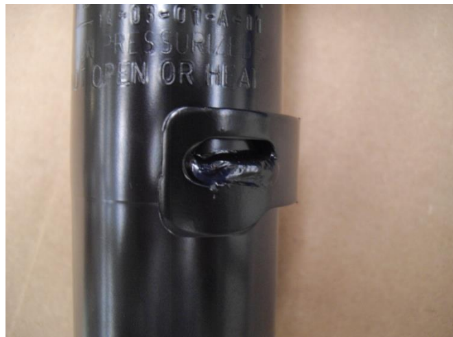
Fig. 67: Detalle del cordón del locator
