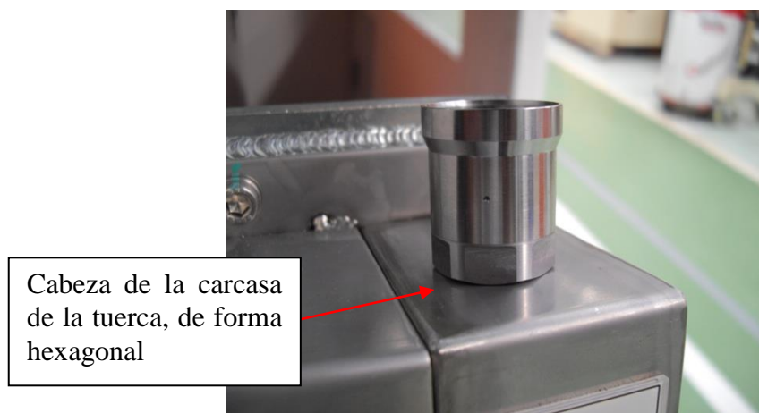
Fig. 113: Tapa-carcasa de la tuerca alternativa
