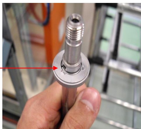
Fig. 99: Detalle mellas en la arandela
