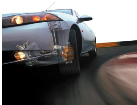
Fig. 4: Suspensión en un coche
