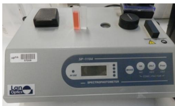
Figura 4.5 Imagen del equipo de medida de absorbancia en la región del visible.
