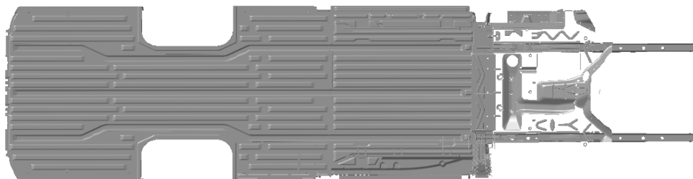
Imagen 4 Vista superior chasis original Mercedes Benz 519 CDI
