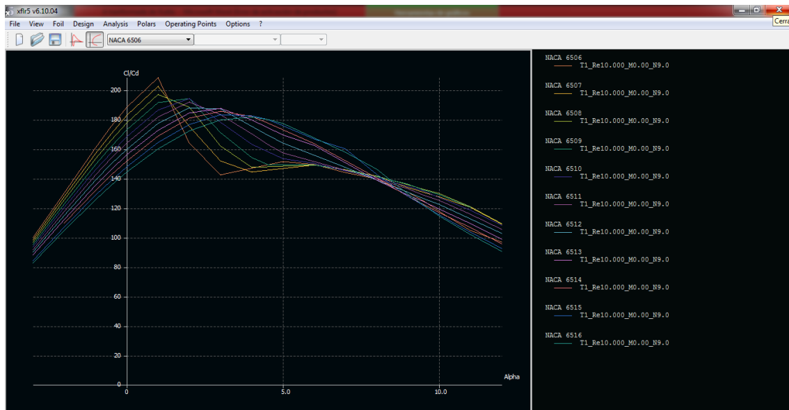
Figura 6.13: Representação dos coeficientes C_L/C_D em função do ângulo de ataque \alpha para os perfis NACA “semelhantes” aos perfis 9-19 gerados por Matlab. Número de Reynolds igual a 1 \times 10^7 .
