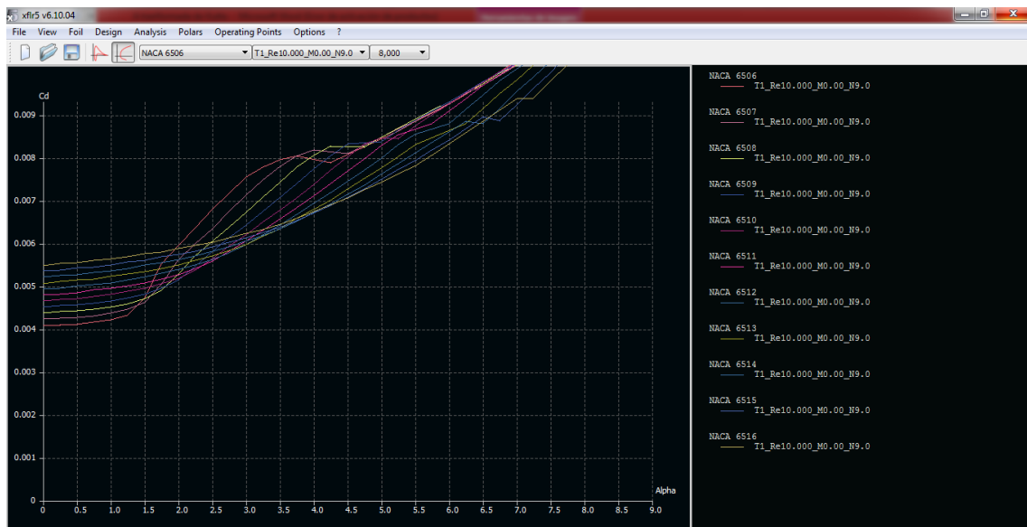
Figura 6.13: Representação dos coeficientes C_D em função do ângulo de ataque \alpha para os perfis NACA “semelhantes” aos perfis 9-19 gerados por Matlab. Ampliada. Número de Reynolds igual a 1 \times 10^7 .
