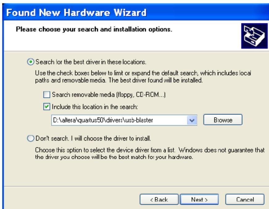
Figura 6. Especificar la dirección del driver
