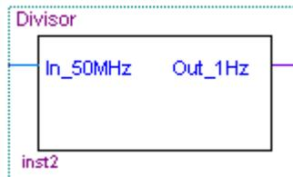
Figura 2. Símbolo divisor de frecuencia 50 MHz → 1Hz
