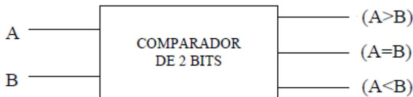
Figura 22. Comparador binario de dos bits
