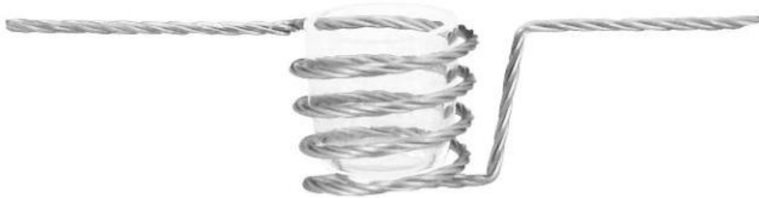
Figura 11.1.5.3 Disposición del crisol en el filamento calentador por conducción
