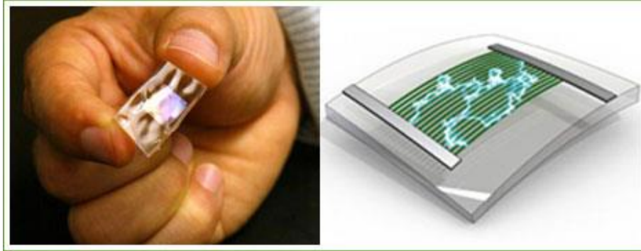
Fig. 3- Chip de goma hecha de PZT (titanato zirconato de plomo). Imagen tomada de (7)
