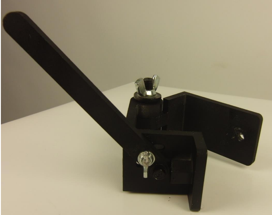
Fig.43-Montaje de la mordaza. Imagen tomada de fotografía.
