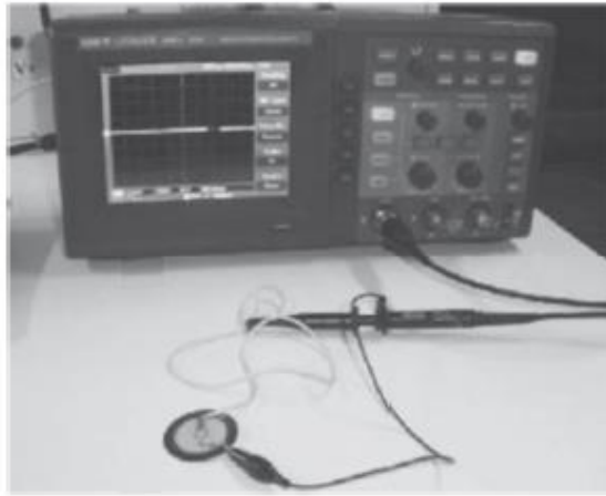
Fig.10- Material piezoeléctrico conectado a voltímetro. Imagen tomada de (13).
