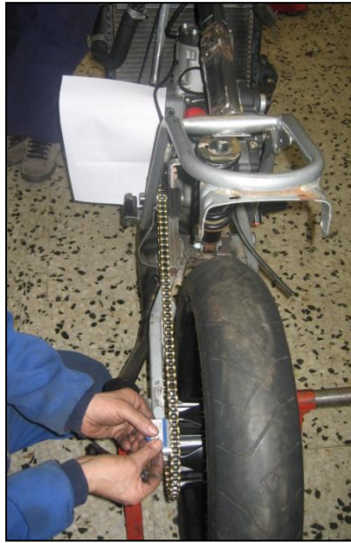
Ajuste de la cadena con láser
