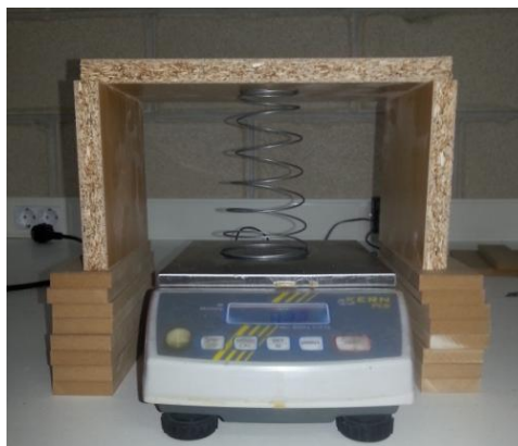
Figura 34. Montaje simulación dinamómetro
