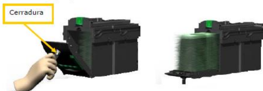
Figura 21. Cerradura módulo de billetes Stacker lock
