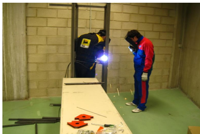
Soldadura de la mesa de trabajo
