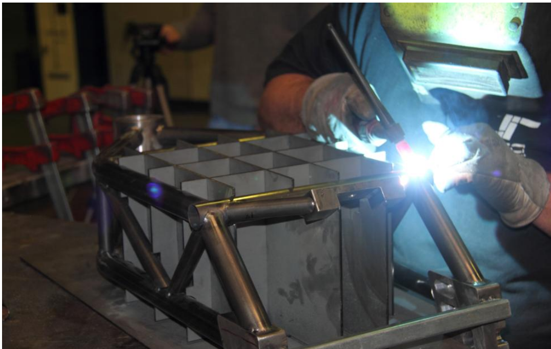
Imagen del operario punteando los tubos del bastidor
