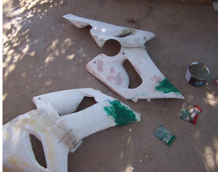
Piezas con la masilla de carrocerero de relleno (verde) y masilla de acabado (gris)
