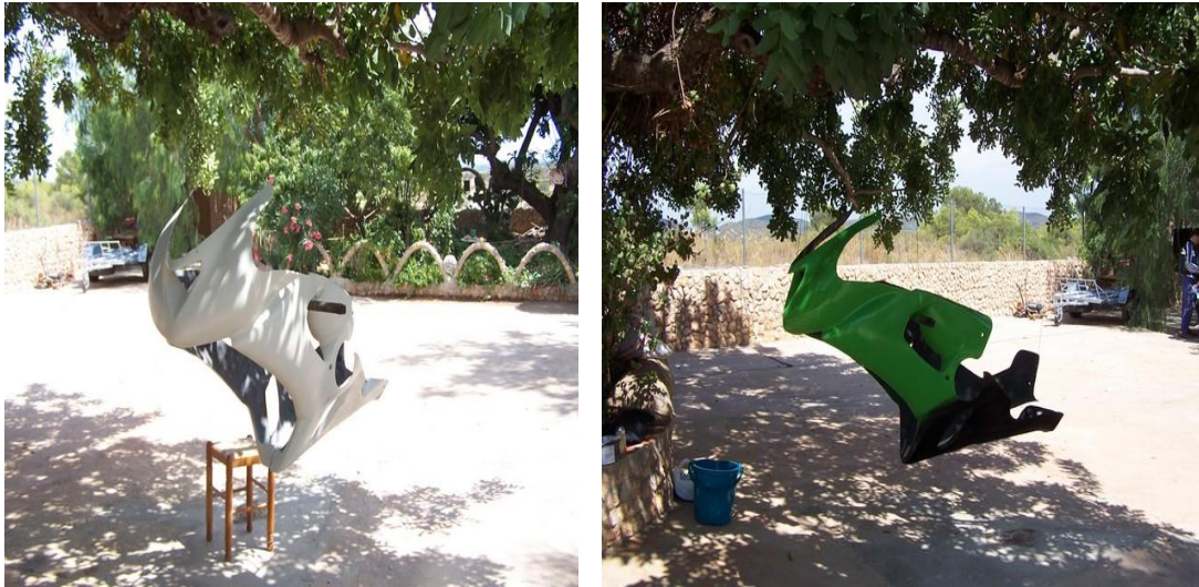
Pintura de la parte frontal y lateral del carenado
