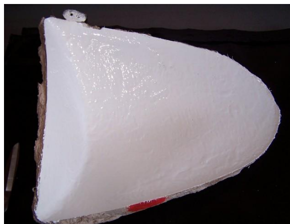
Aplicación del gel coat a la pieza
