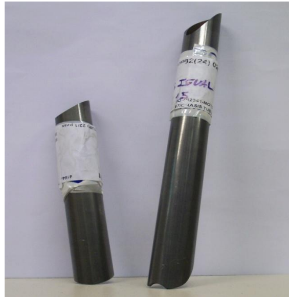
Corte a láser de los tubos Reynolds 631
