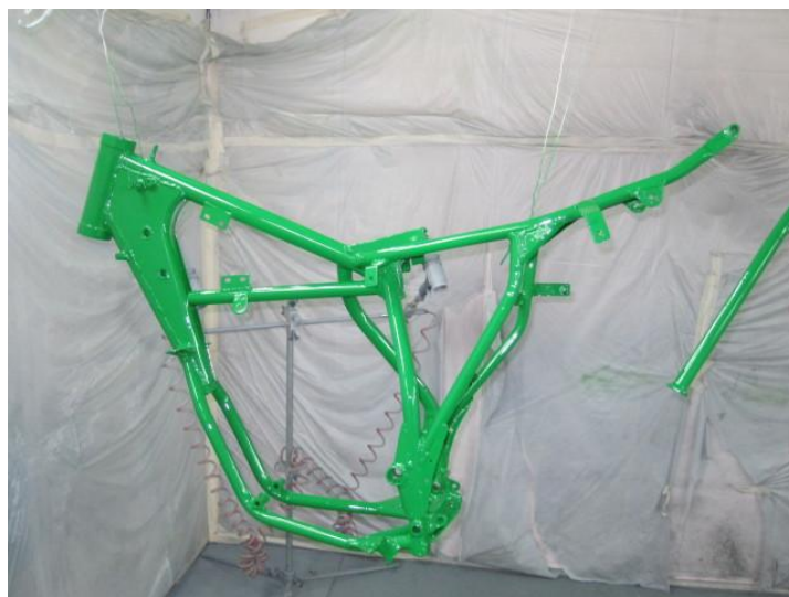
Proceso de pintura del chasis de una motocicleta
