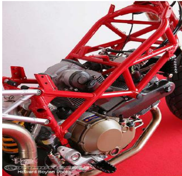
Chasis tubular fabricado con tubos de acero de alta resistencia
