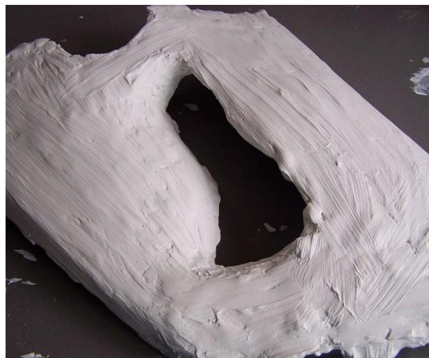
Pieza de carenado pintada de escayola
