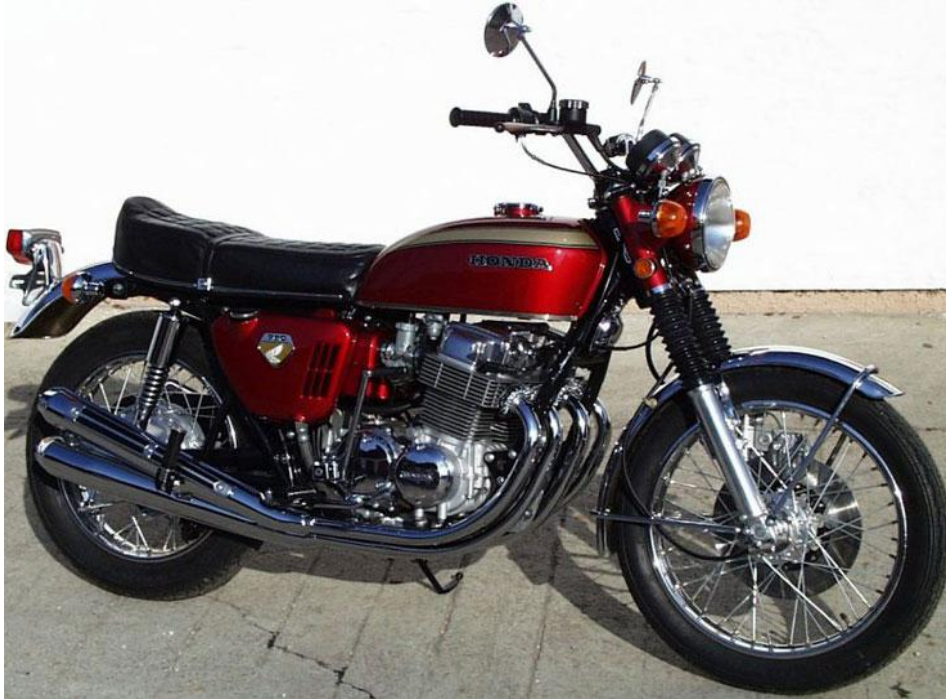
Motocicleta Honda de 1970 con el motor de cuatro cilindros cuatro tiempos
