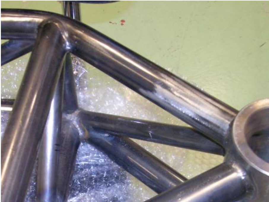
Detalle de la soldadura TIG del bastidor
