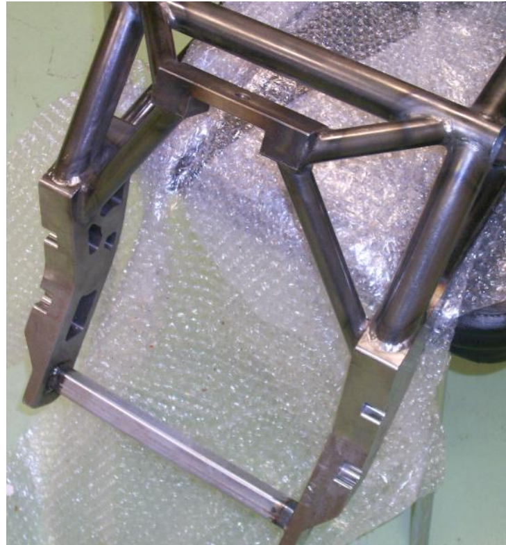
Imagen trasera del chasis soldado
