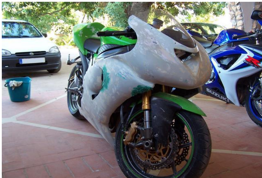
Carenado con una mano de imprimación
