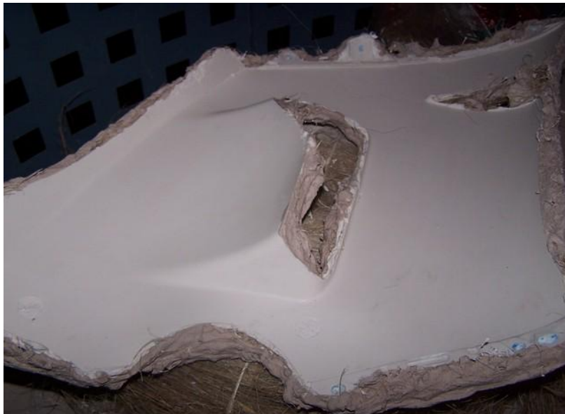
Pieza de escayola desmoldeada endurecida con esparto
