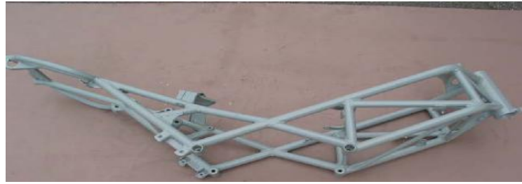
Prototipado rápido de un chasis de tubos de aluminio
