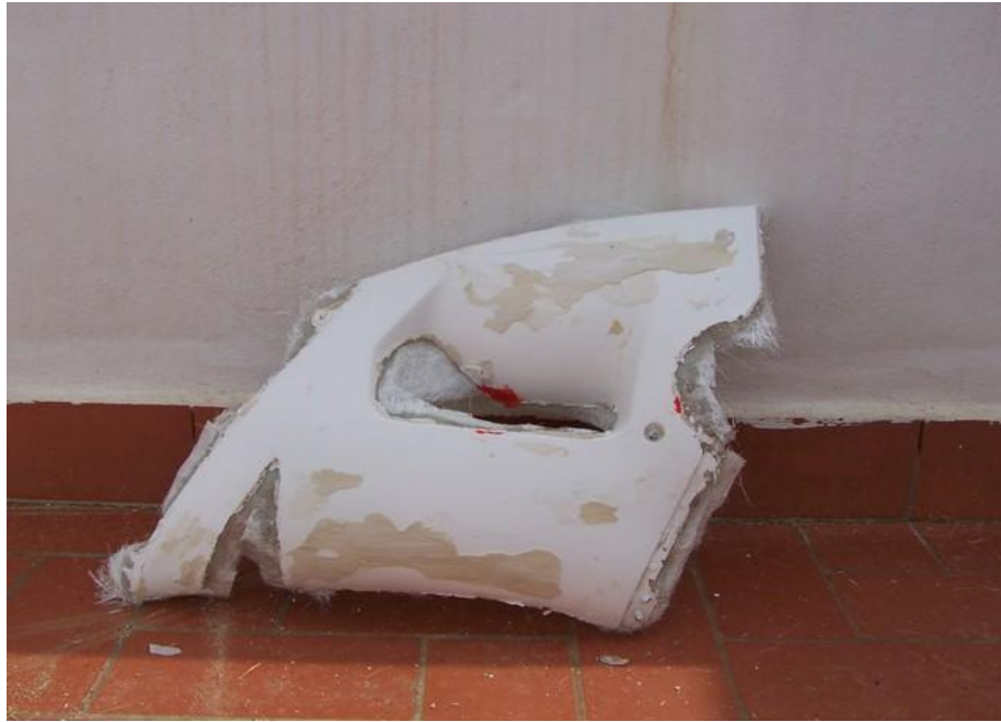
Aspecto de una de las piezas del carenado en fibra de vidrio al desmoldar
