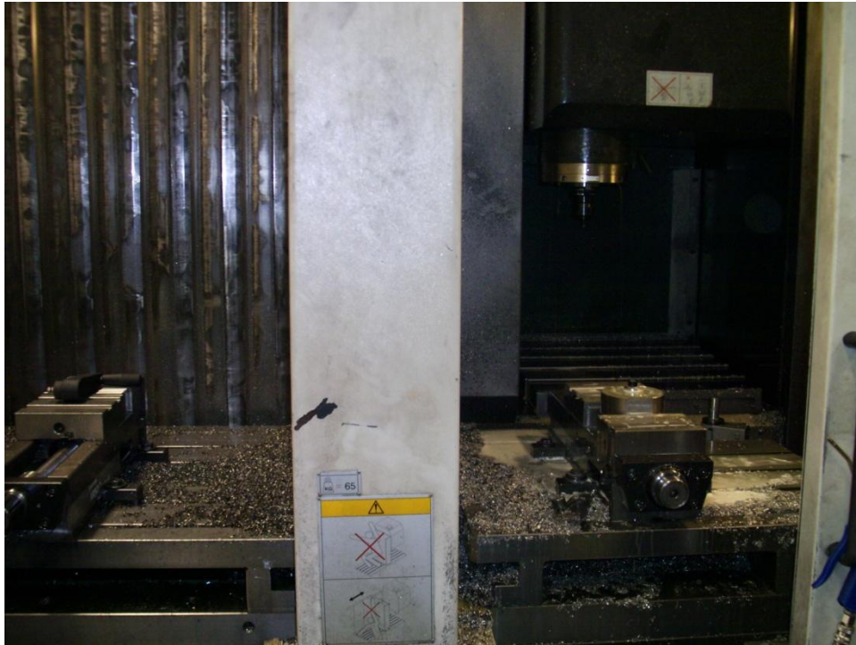
Centro de mecanizado de 4 ejes de CODI
