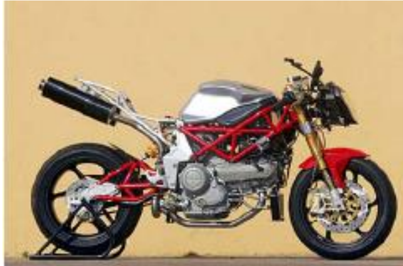
Chasis de acero de alta resistencia de la Ducati Monster de calle
