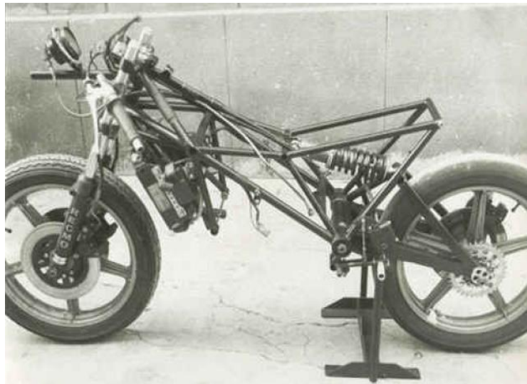
Ejemplo de chasis tubular triangulado
