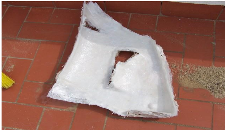
Aspecto de la pieza de fibra de vidrio desmoldada
