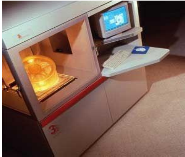
Máquina de estereolitografía modelando una llanta
