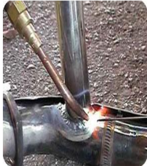
Ejemplo de Soldadura por fusión
