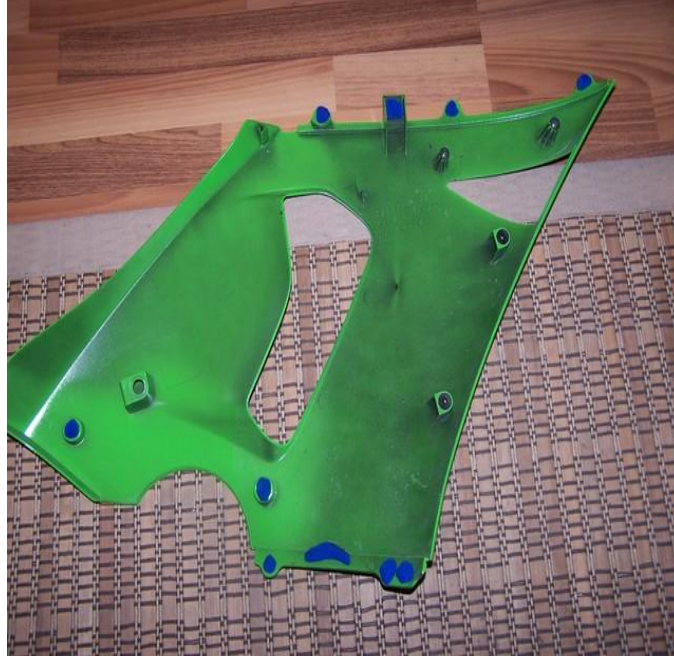
Pieza de carenado limpia y preparada
