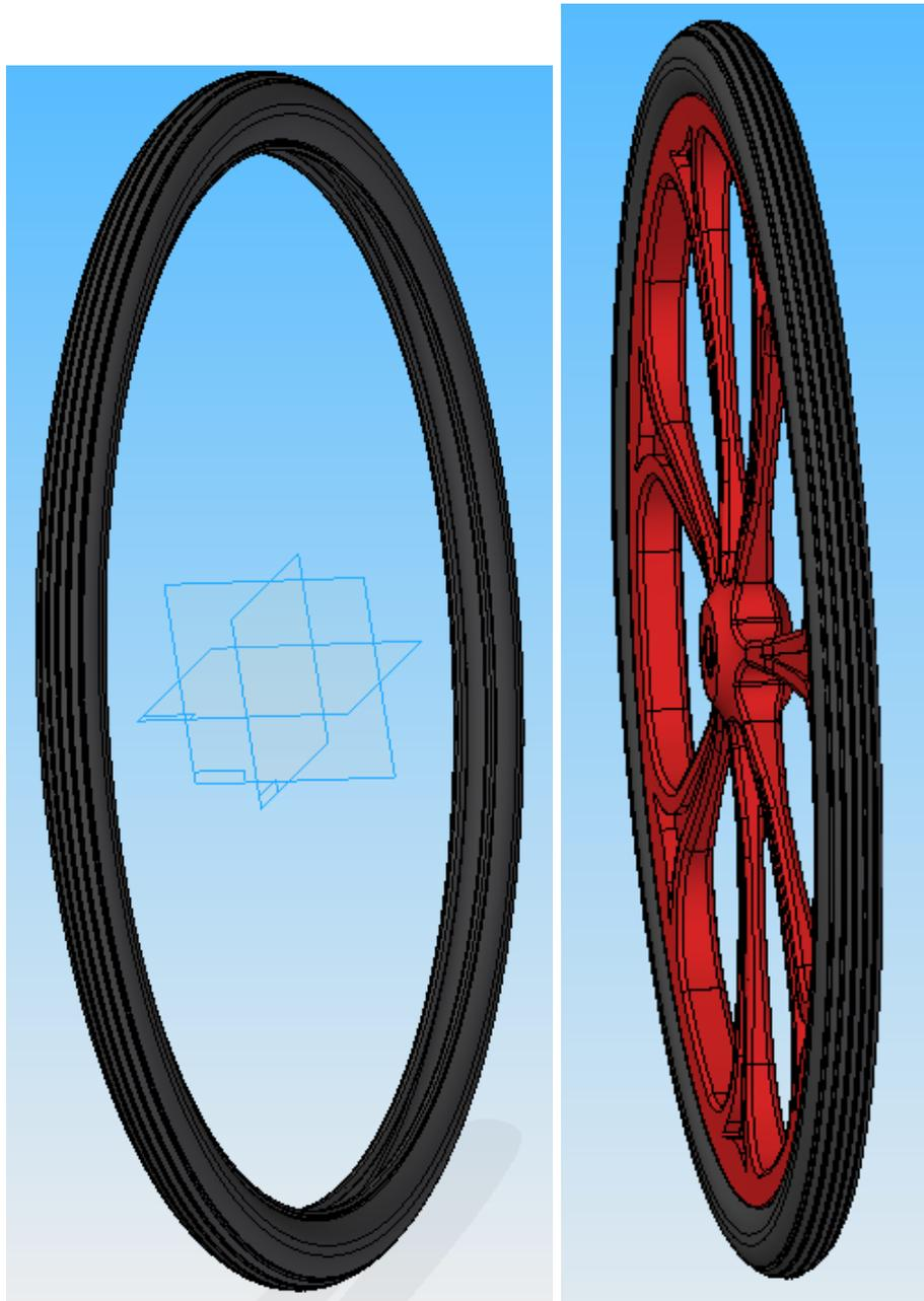
En el buje se encuentra la zona que producirá el giro libre de la rueda completa sobre el eje. El giro suave del buje y rueda se produce gracias a dos rodamientos situados en el interior del mismo. Se trata de dos rodamientos de bolas. Son usados en una gran variedad de aplicaciones. Son fáciles de diseñar, no separables, capaces de operar en altas e incluso muy altas velocidades y requieren poco mantenimiento en servicio.
