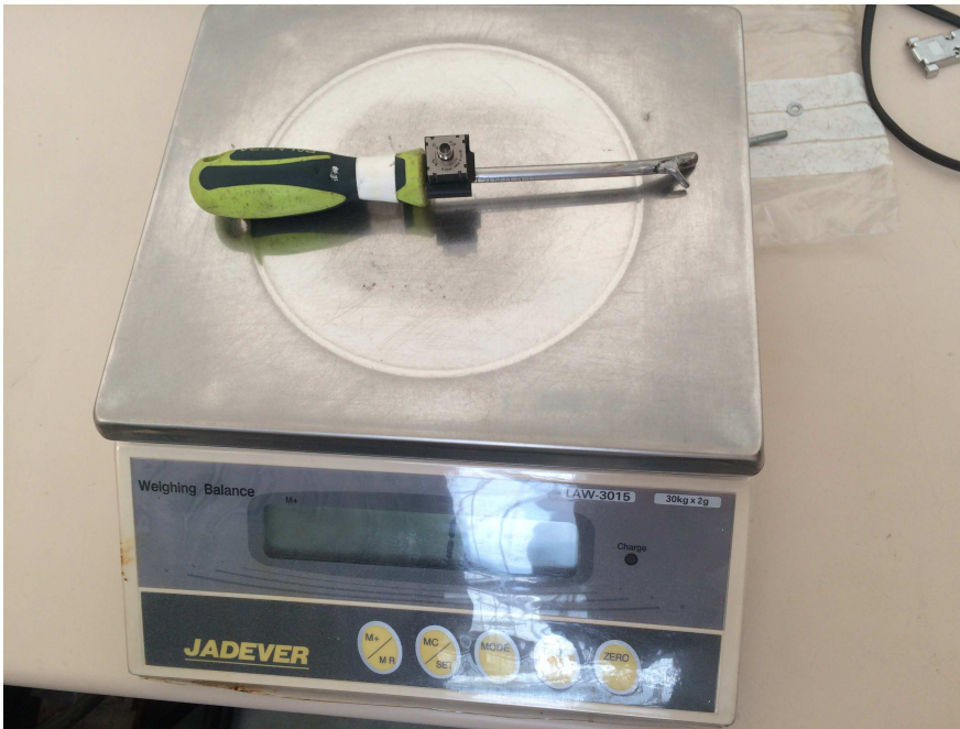
Figura 34 Conjunto herramienta+acelerómetro medido en báscula
