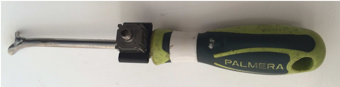
Figura 21 Envarillador con el acelerómetro triaxial colocado
