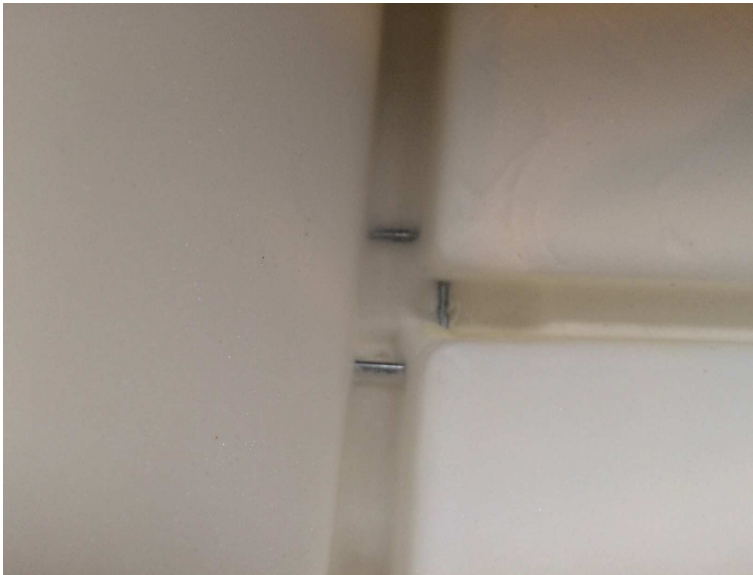
Figura 14 Insertos metálicos de la espuma donde se enganchan las varillas de las fundas
