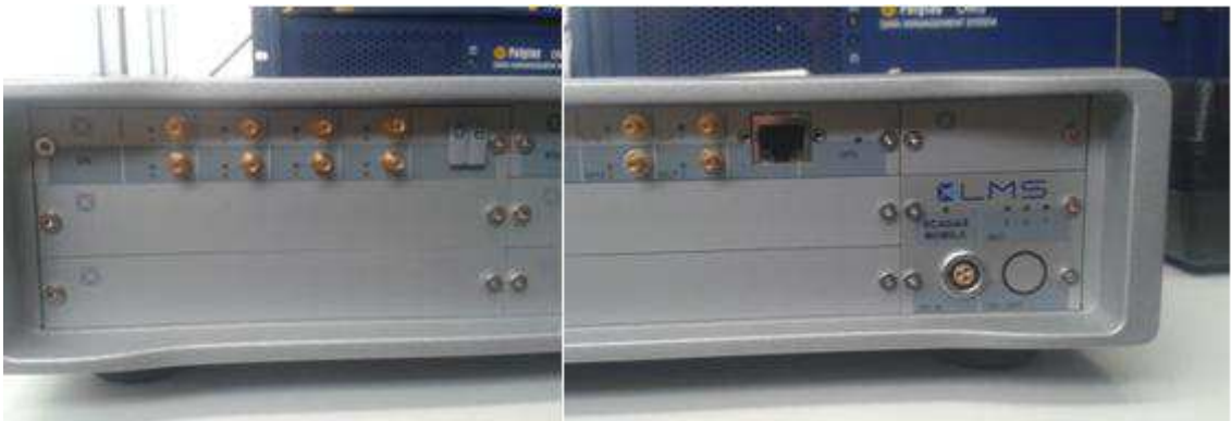
Figura 24 Canales de entrada y salida del SCADAS MOBILE
