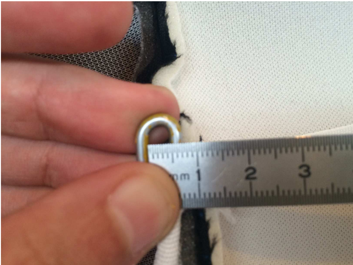
Figura 108 GAP existente en la curva de la varilla de la funda donde se engancha la punta del envarillador
