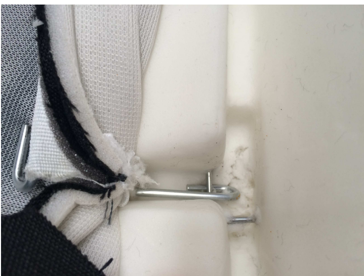
Figura 17 Varilla de la funda enganchada al inserto de la espuma
