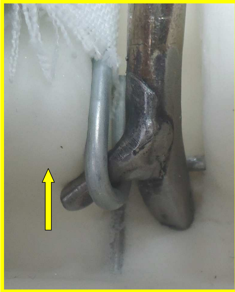
Figura 93 Carga de flexión a la que está sometida la varilla
