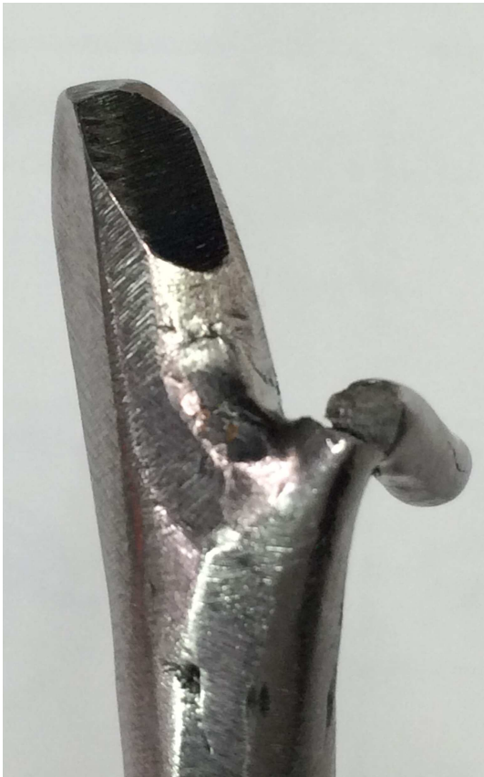
Figura 19 Rotura de la herramienta envarillador
