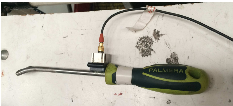
Figura 28 Acelerómetro pegado a la herramienta con el cable conectado al SCADAS MOBILE
