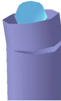
Figura 46: Masa puntual que simula la nacelle vista en estructura sólida en Genie.
