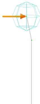
Figura 62: Carga puntual de 800 KN aplicada en el centro de la masa puntual del modelo generado en Genie.
