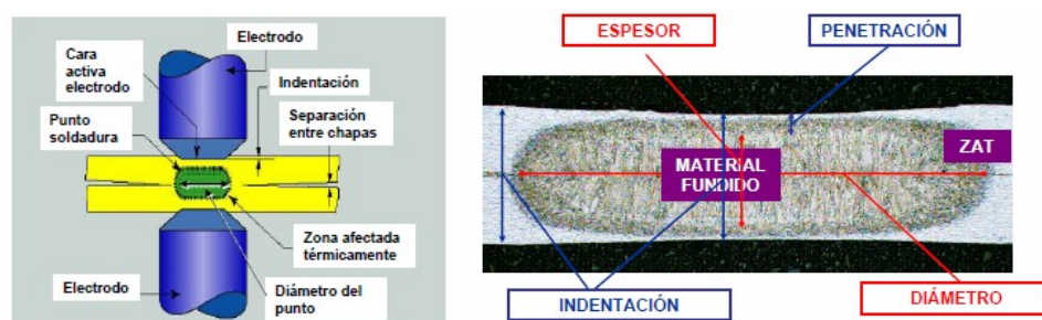
Figura 4.52: Vista esquemática del proceso de soldadura por puntos y de la “lenteja” o punto de soldadura resultante con sus características principales
