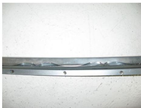
Figura 4.53: Prueba del cincel y el martillo. Ejemplo de soldadura correcta
