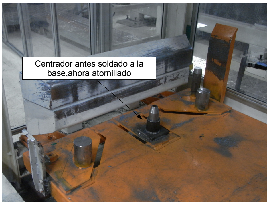
Figura 4.10: Centraores atornillados a la base del nicho
