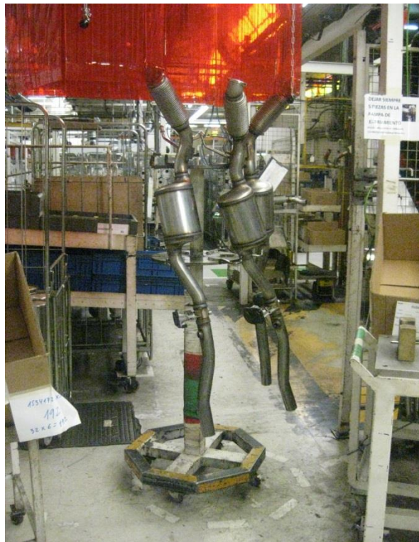
Fig 6.6 Percha de enfriamiento (bailarina)
