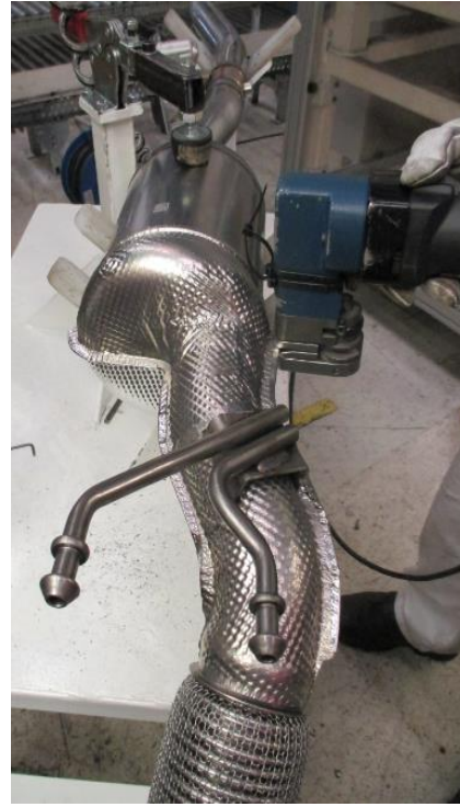
Fig 6.9 Planchado de las solapas
