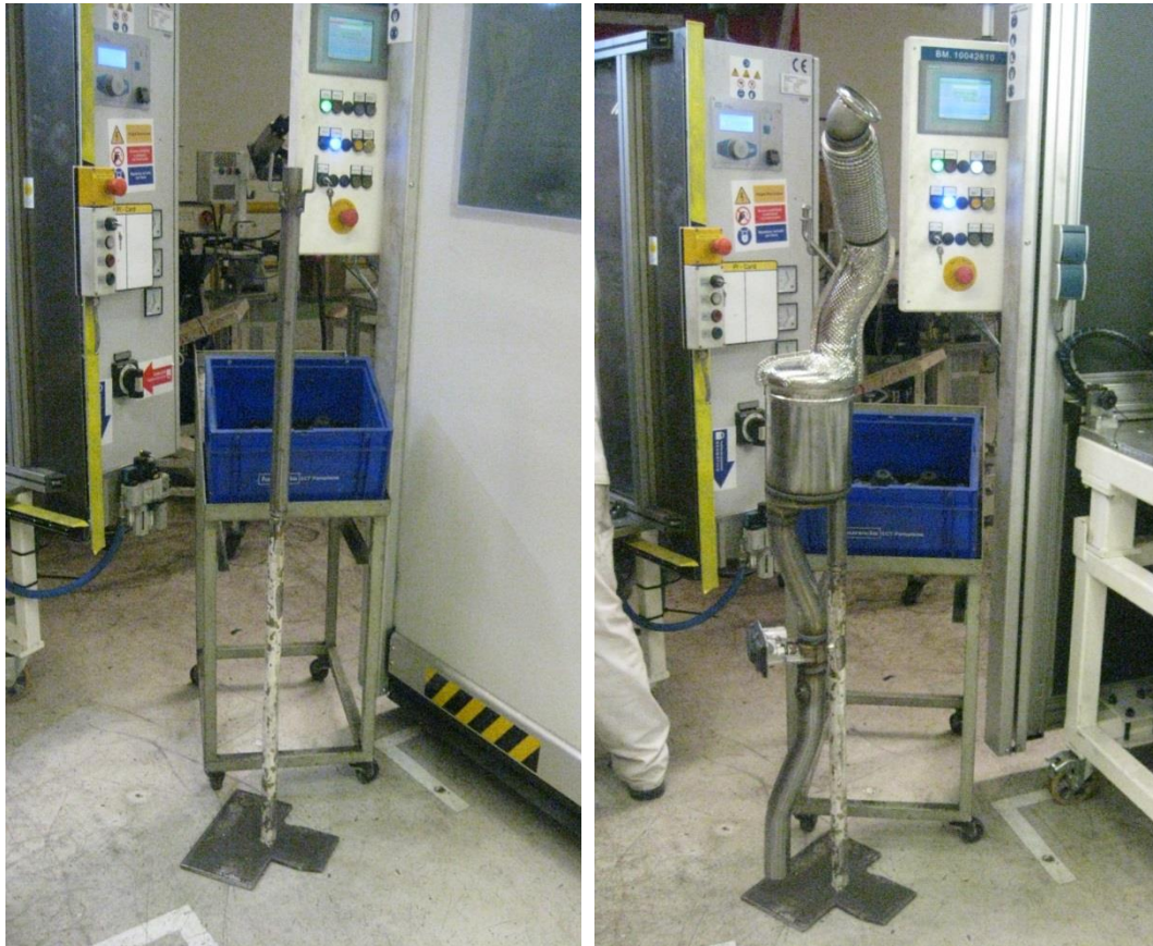
Fig 6.31 Soporte instalado en el puesto 2
