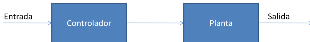
Fig. 4: Diagrama de bloques de un control en lazo abierto
