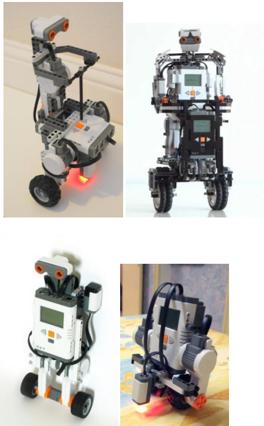
Fig. 12: Configuraciones mecánicas para segway basado en Lego
