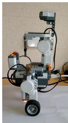
Fig. 21: Configuración final del robot segway
