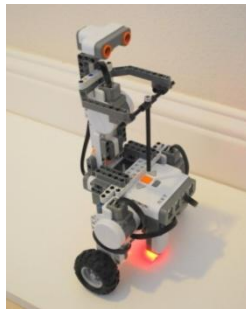
Fig. 20: Configuración inicial del robot segway
