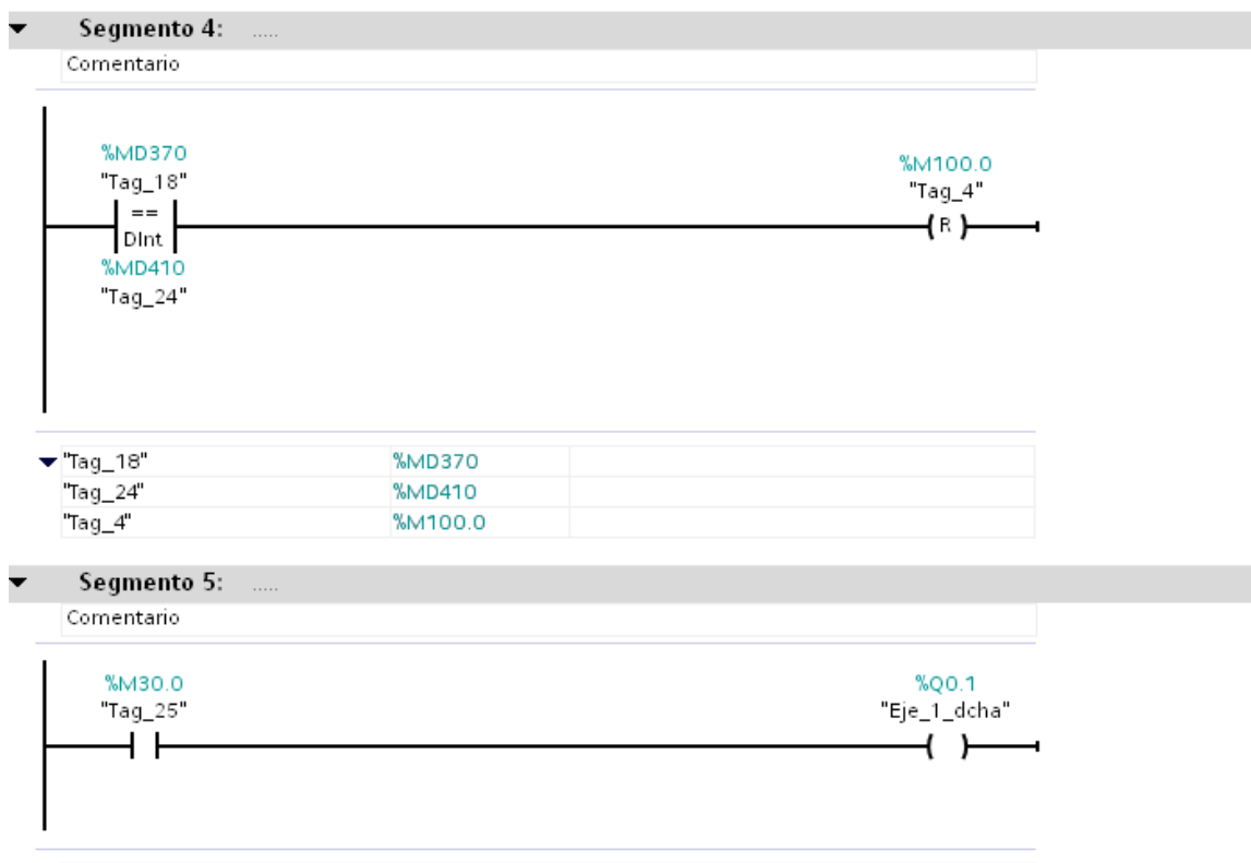
Figura 91: Detener generador PWM
