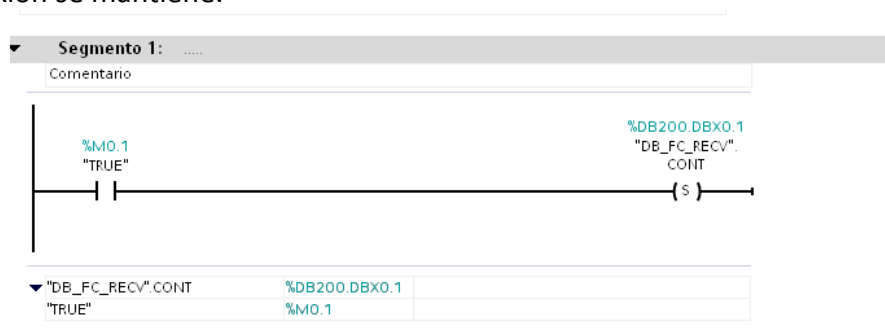
Figura 43: Activar estado de la conexión PLC2
