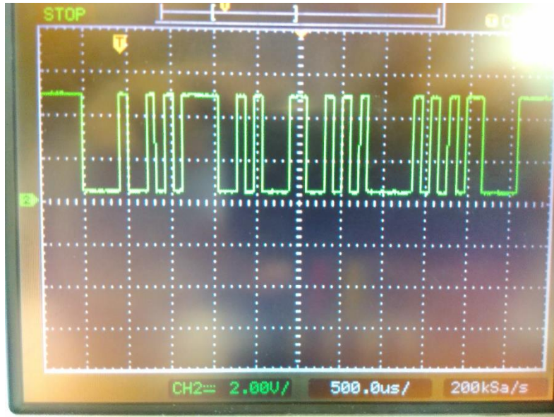
Ilustración 80. Trama de datos correspondiente a "Hola" recibido por el pin RX0 de Arduino UNO.
