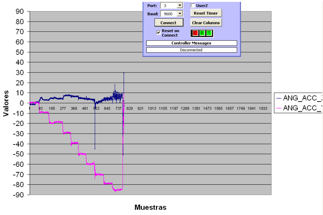
Ilustración 49 Ensayo realizado sobre el eje Y con constante de ajuste.
