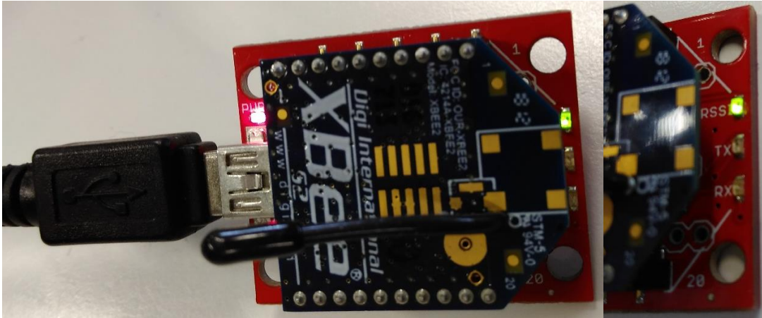
Ilustración 78. Comunicación establecida entre los módulos XBee. Prueba hardware. Los LED de arriba abajo: RSSI, TX, RX.
