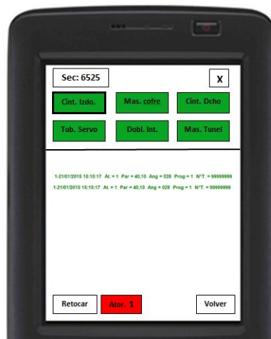
[Figura 48: Imagen de la visualización de la pantalla de la PDA después de hacer la lectura del código de barras que incorpora cada coche (estos códigos de barras son diferentes para cada coche)]
