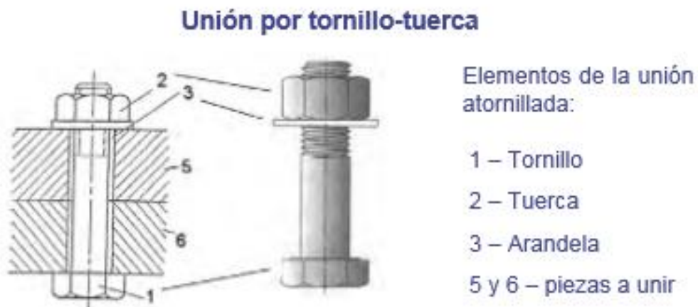
[Figura 15: Unión atornillada por unión tornillo – tuerca]
