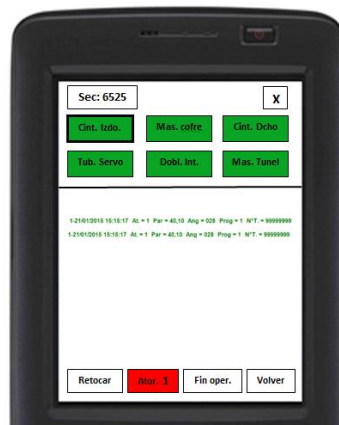
[Figura 53: Visualización de la PDA con el botón fin de operación]
