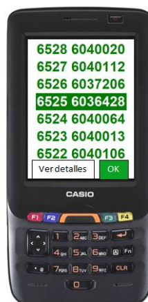
[Figura 45: Visualización en la PDA de los datos cíclicos pedidos al servidor web]
