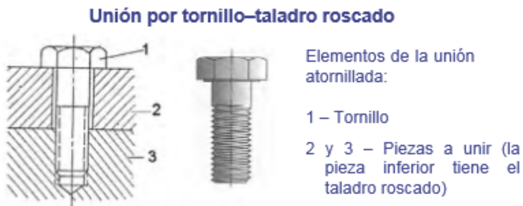
[Figura 16: Unión atornillada por tornillo – taladro roscado]
