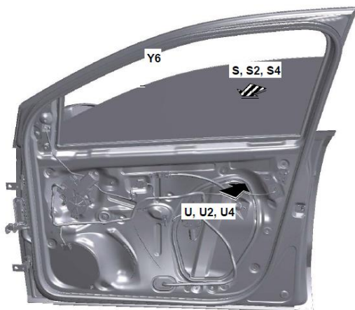
[Figura 5: Estructura metálica de la puerta]
