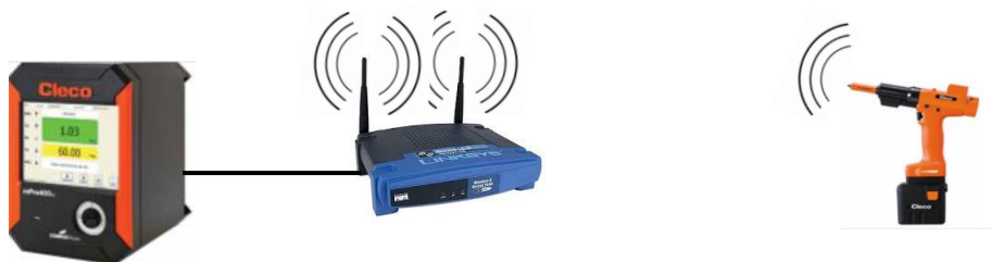
[Figura 43: comunicación herramienta - controlador]
