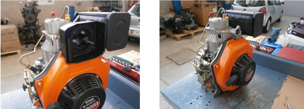
Figura 15: a) Conjunto de escape acoplado y b) escape desinstalado.
