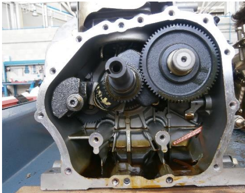
Figura 21: a) Con árbol de levas y b) sin árbol de levas.
