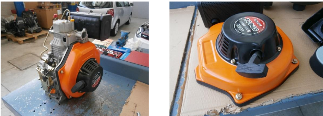
Figura 16: a) Motor de arranque manual acoplado y b) motor desacoplado.
