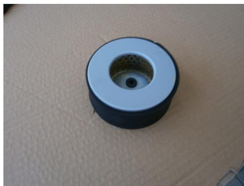
Figura 14: Filtro de aire.
