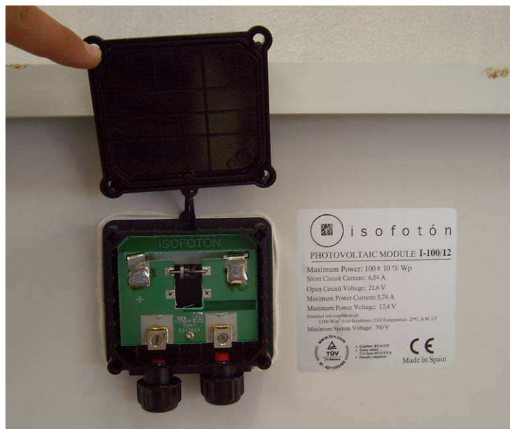
Figura 17.- Borne positivo del Panel Solar Isofotón.
