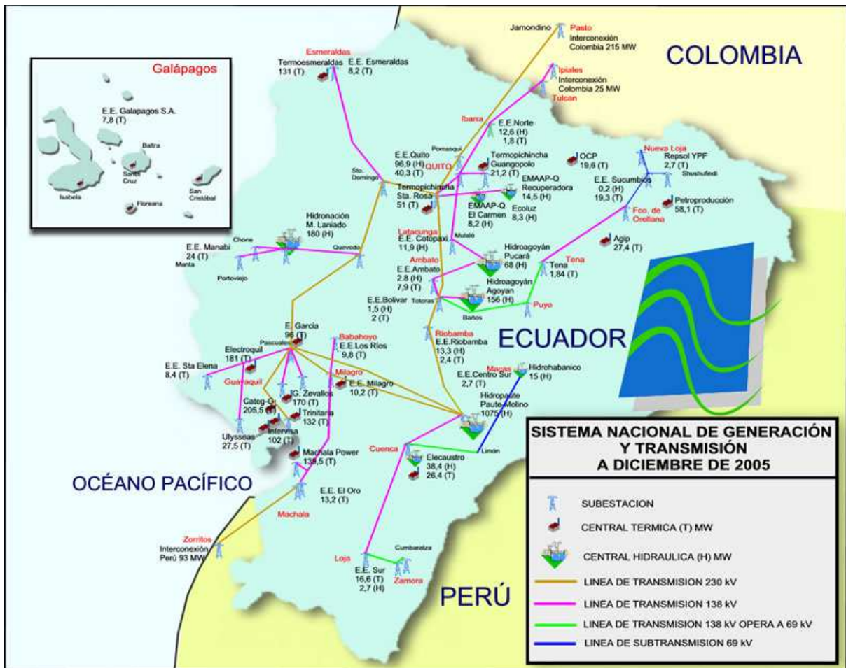
Figura 13. Mapa del sistema nacional de generación y transmisión de Ecuador (fuente: CONELEC)
