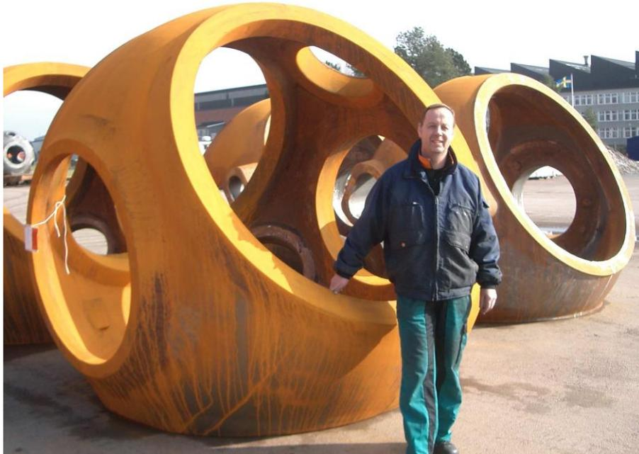
Figura 2.3: buje para un aerogenerador Siemens SWT de 2.3 MW; peso 12 Toneladas (Eiritz, 2009).
