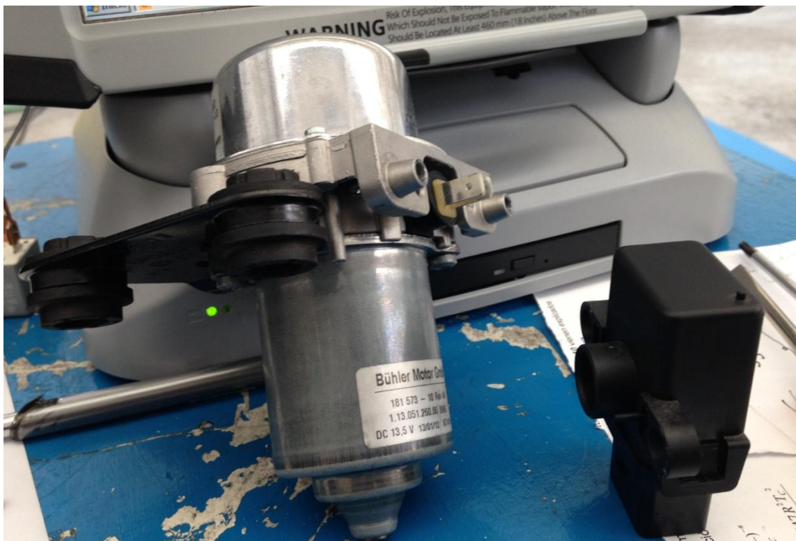
ILUSTRACIÓN 18: BOMBA DE VACÍO Y CONJUNTO ELECTRÓNICO DESMONTADOS
