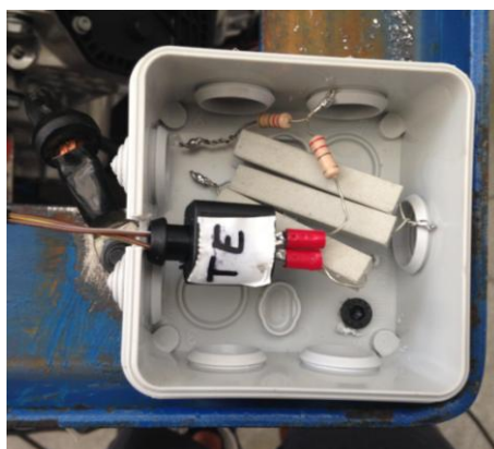
ILUSTRACIÓN 13: SENSOR FALSEADO DE LA TEMPERATURA AMBIENTE
