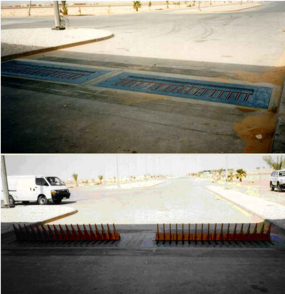
Fotografía que muestra un Spike Barrier en su posición horizontal dejando pasar los vehículos y en su posición activada que impide el paso. Este modelo de barrera levanta los dientes casi medio metro con lo cual imposibilita el paso en cualquier sentido. (Figura 1.16)
