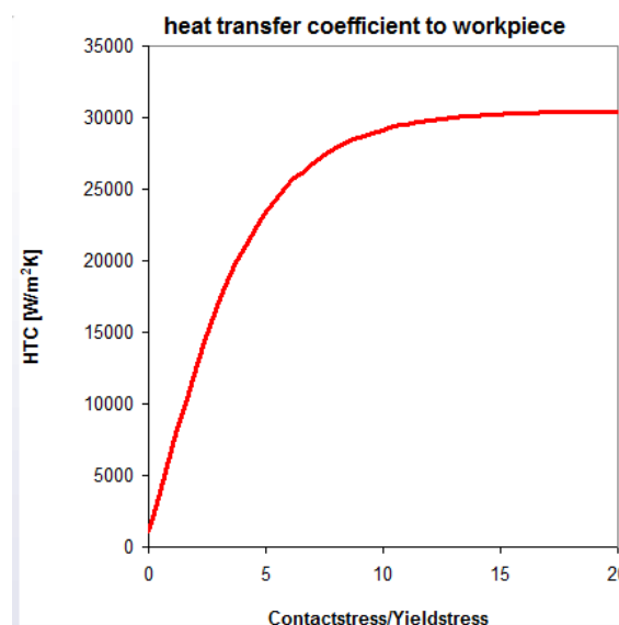
Ilustración 4.9 Transmisión de calor pieza-matriz
