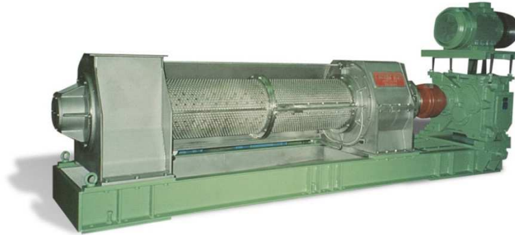
Ilustración 2.5 Prensa de tornillo
