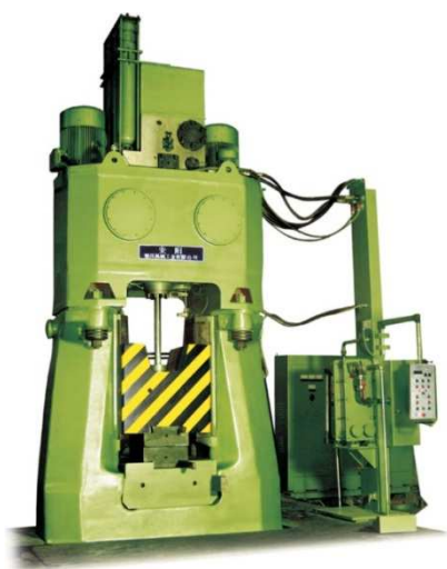
Ilustración 2.7 Martinete accionado por energía
