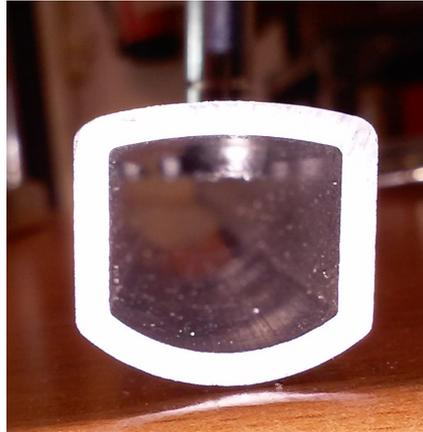
Figura 36. Resultado de perfil curvo de espesor 2,33mm
