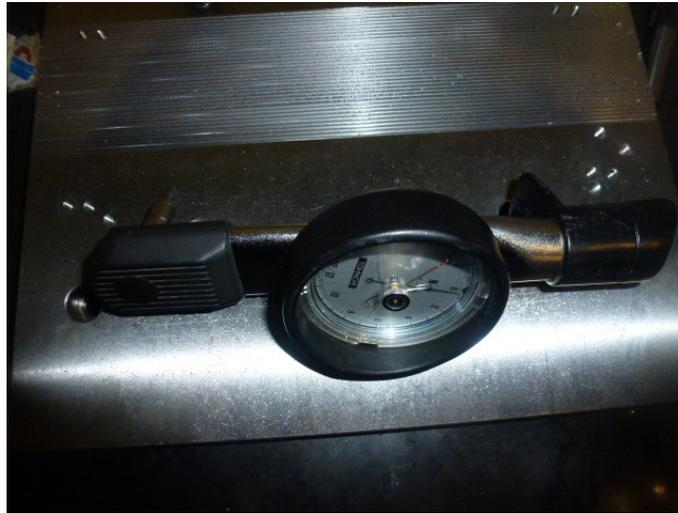
Figura 251. Llave dinamométrica
