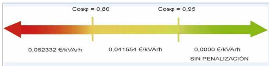
Figura 2.20. Término de reactiva. Fuente: Gesternova http://blog.gesternova.com/energia-reactiva/
