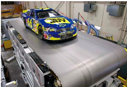
Figura 5.23: El objetivo de un suelo móvil, es simular el perfil de velocidades la capa límite por debajo del coche.
