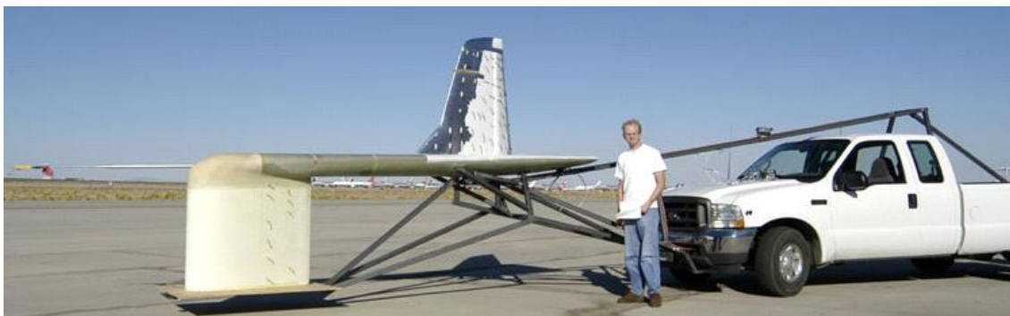
Figura 6.9: Un metodo ingeniosa para analizar efectos aerodinámicos.
