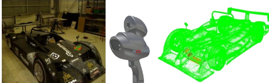
Figura 6.3: Escaneado de un coche con un escáner laser.
