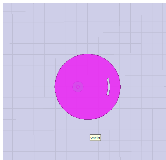
Figura 4.24 Slot en parche circular
