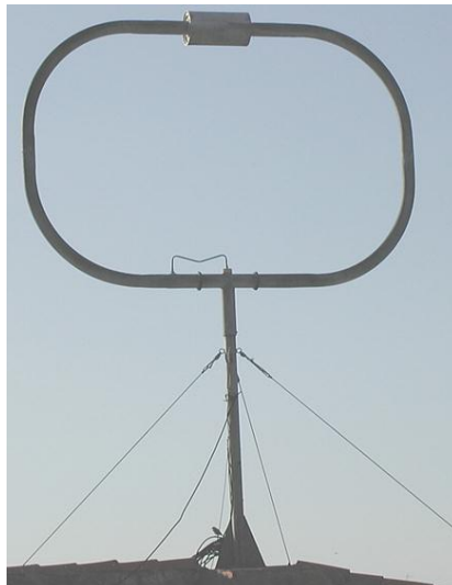
Figura 2.12 Antena de espira geometría cuadrada-circular
